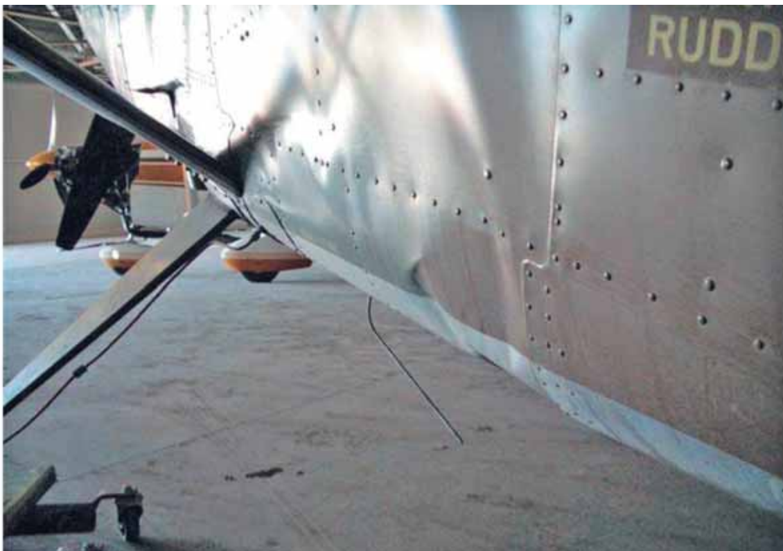
Particolare dei danni alla fusoliera.
