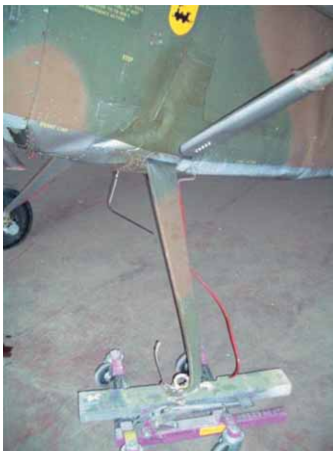
Particolare dei danni al carrello.
