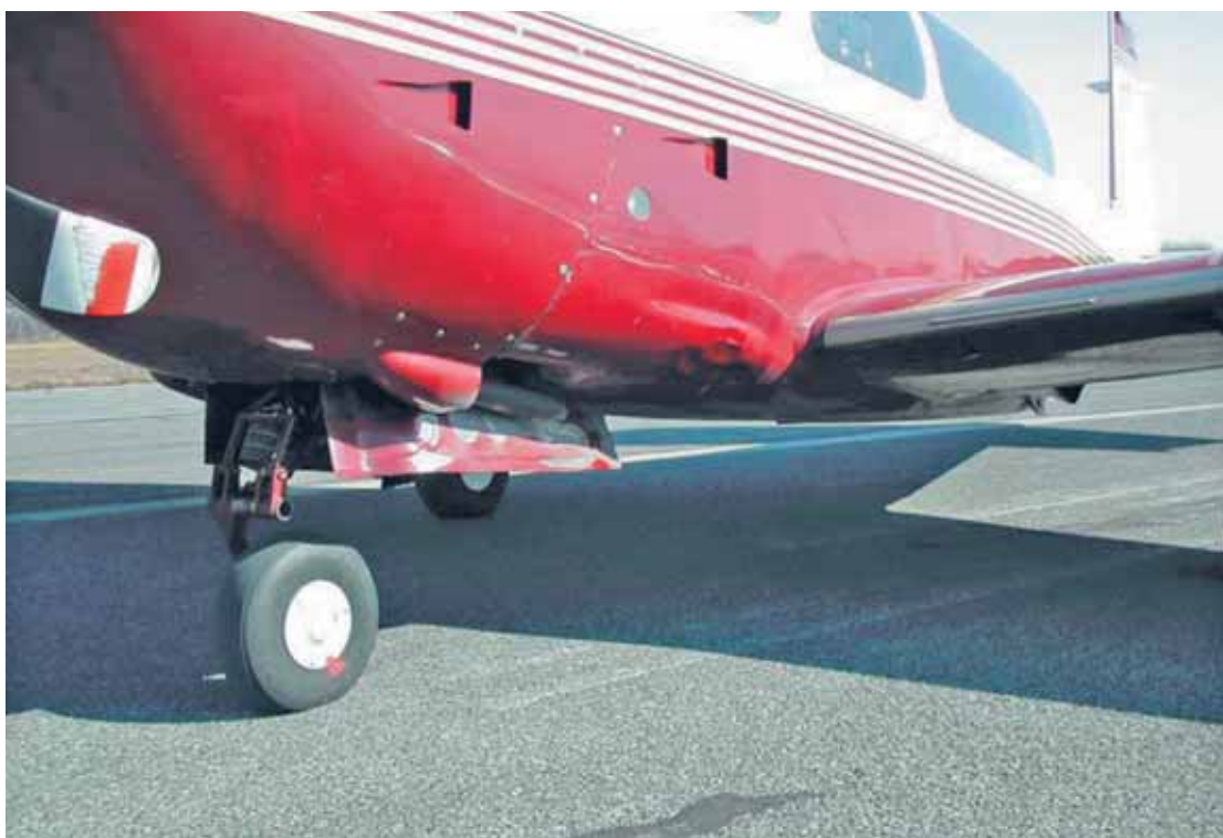
Particolare dei danni al vano carrello.
