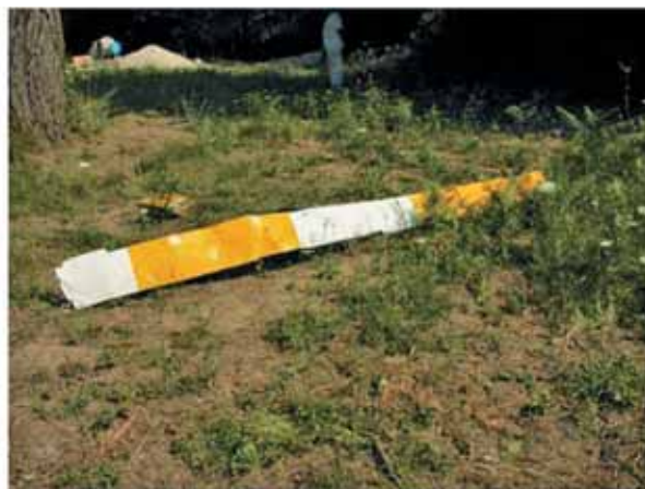
Frammenti delle pale del rotore principale.
