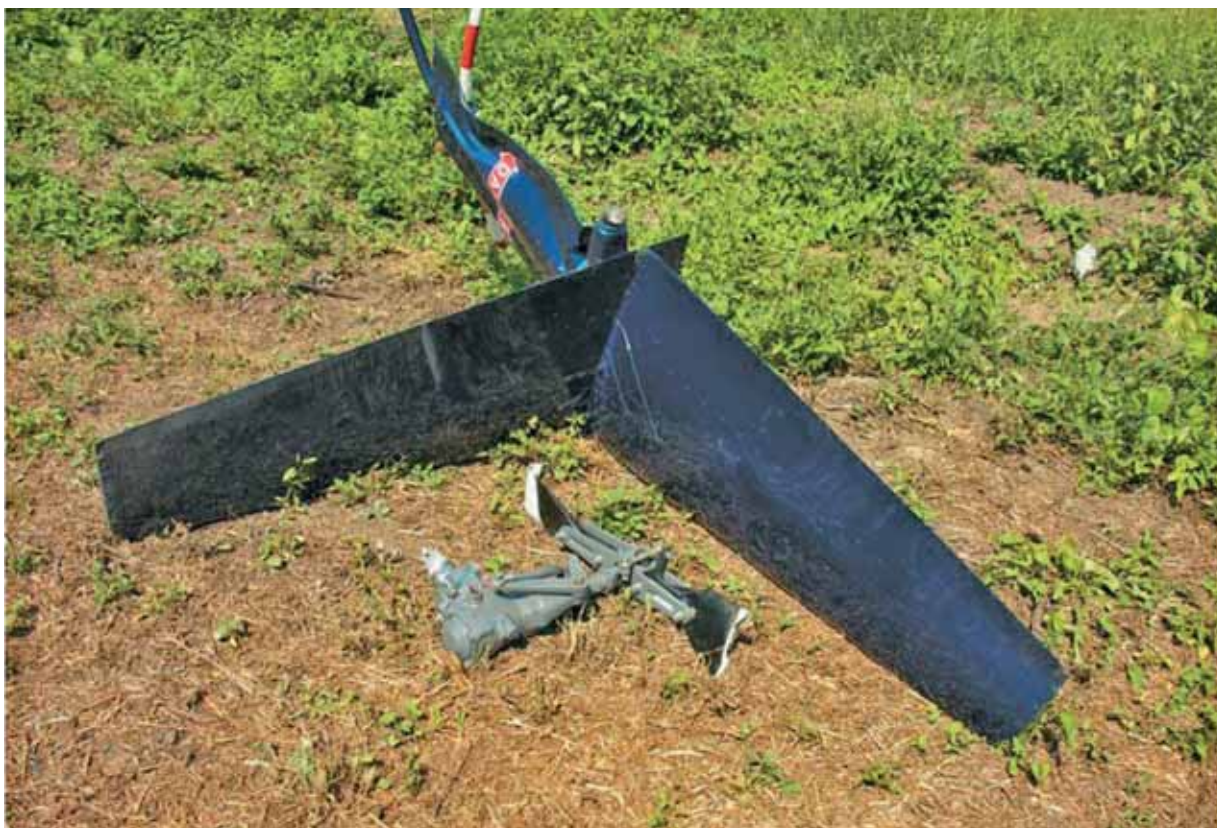
Meccanismi del rotore anticoppia (si notino i tronconi delle pale recise).
