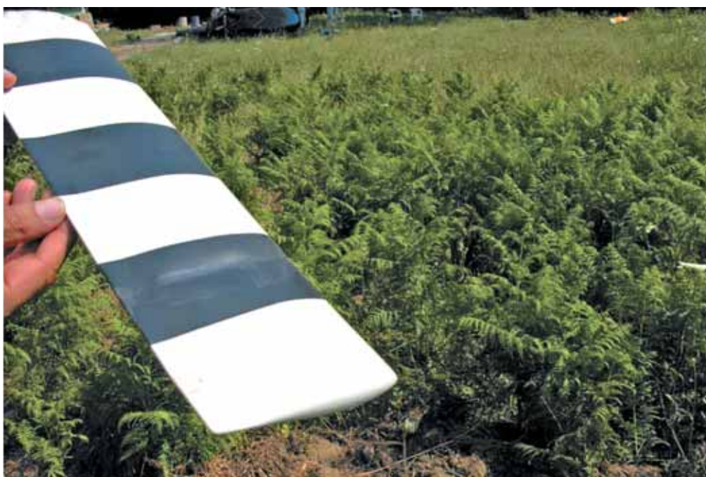
Impronta sul dorso di una delle pale del rotore anticoppia.
