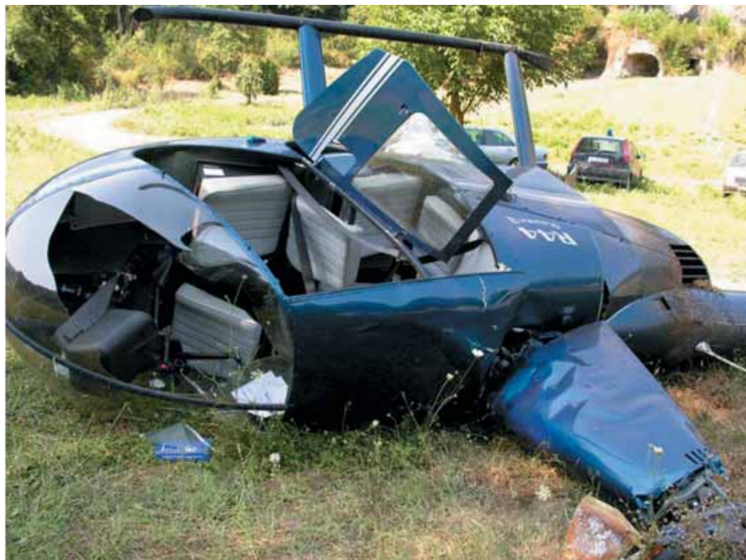
Particolare dei danni alla cabina.
