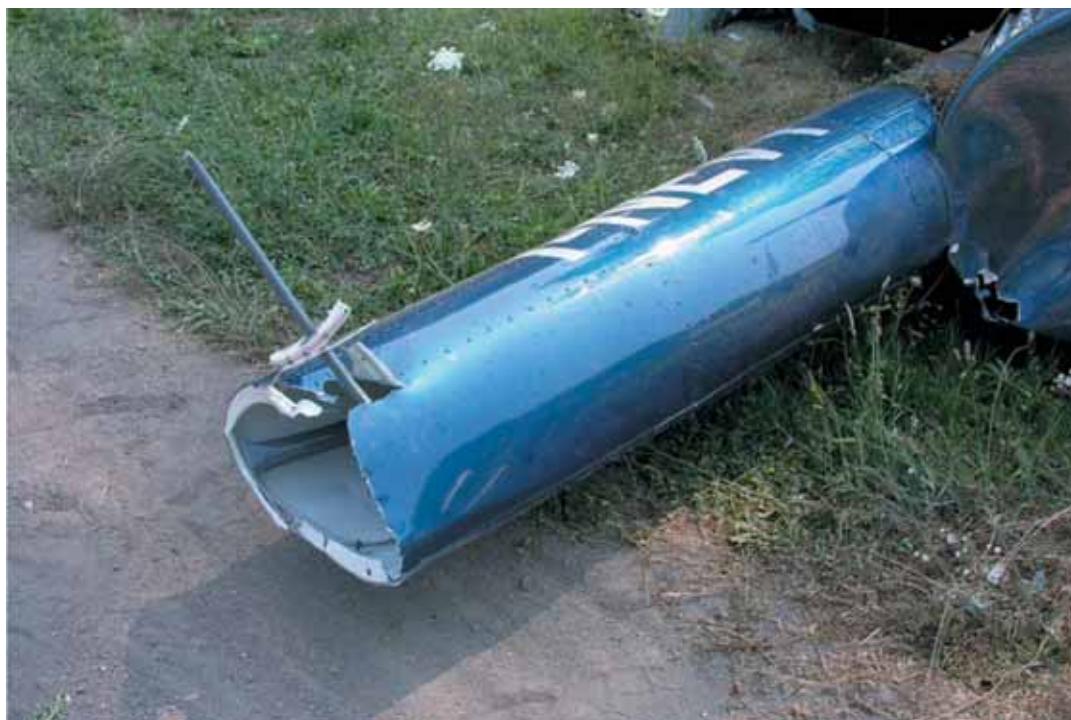
Trave di coda tranciata.
