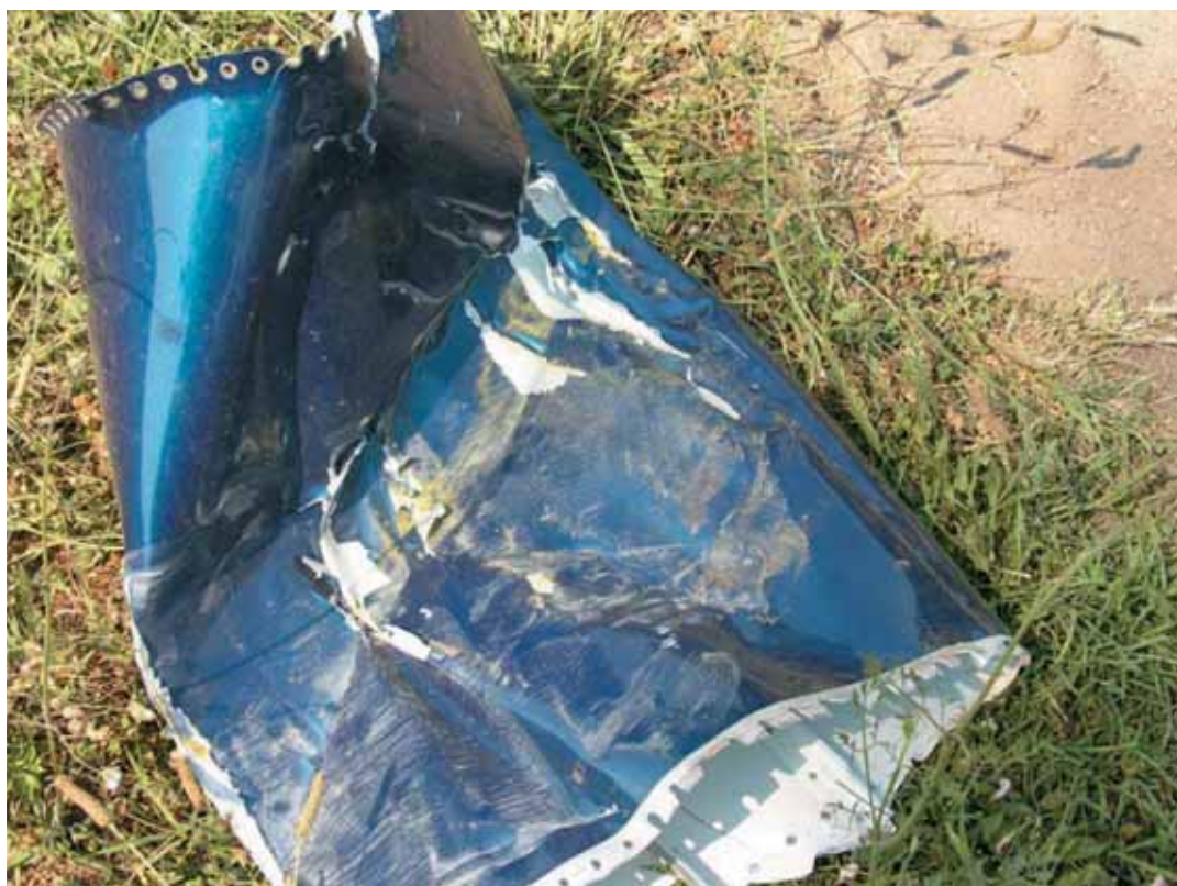
Particolare della colorazione gialla sulla parte rescissa della trave di coda.
