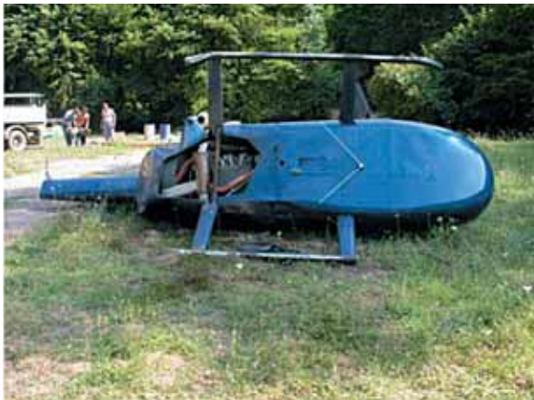
Squarcio sulla base della cabina e interno del motore.
