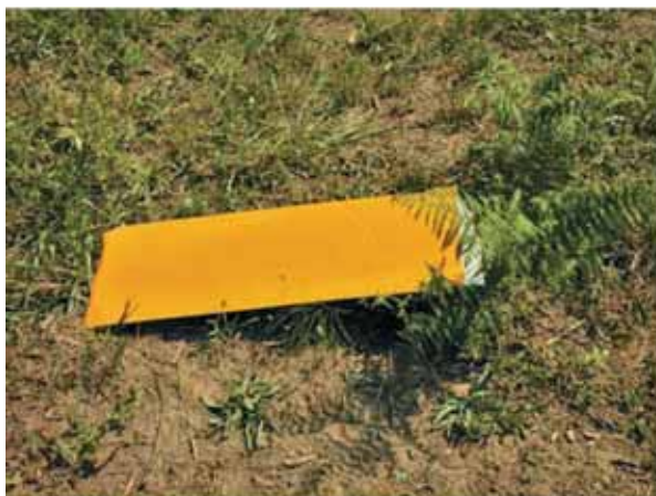
Frammenti delle pale del rotore principale.
