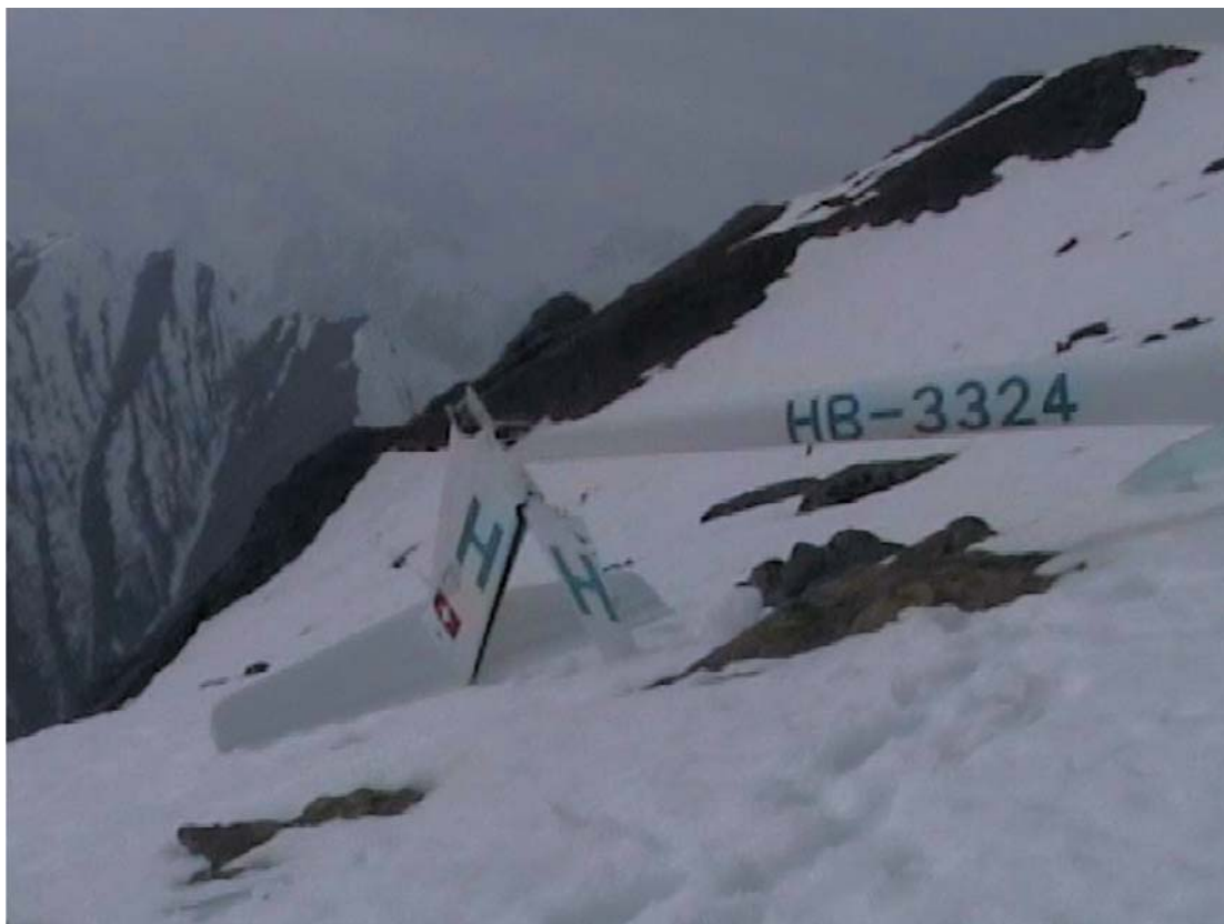
Rottura della trave di coda.
