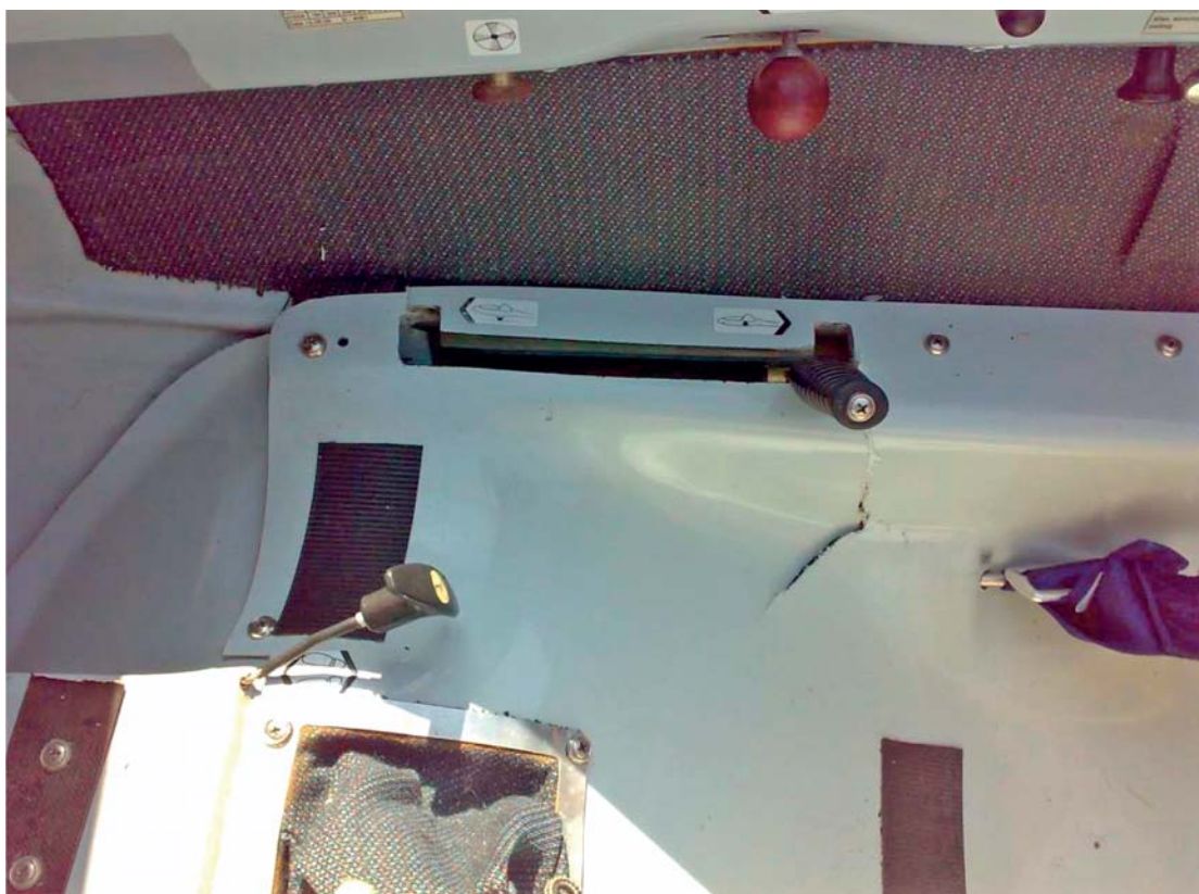
Particolare dei danni in cabina di pilotaggio.
