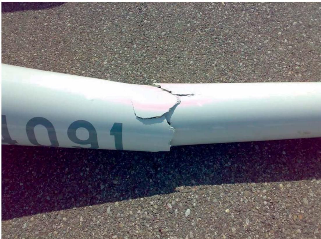
Particolare dei danni al troncone di coda.
