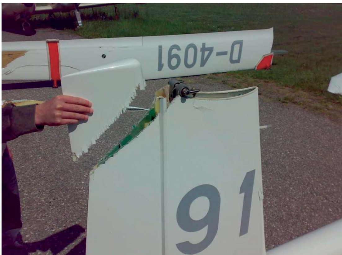
Danni al timone di direzione.
