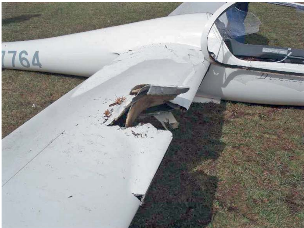
Particolare danni semiala destra e tettuccio.
