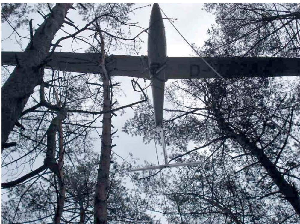
Vista, da sotto, della zona di impatto e dei danni alla trave di coda.
