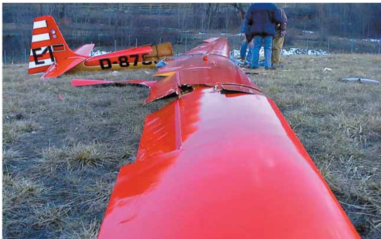
Particolare dei danni alla semiala destra.
