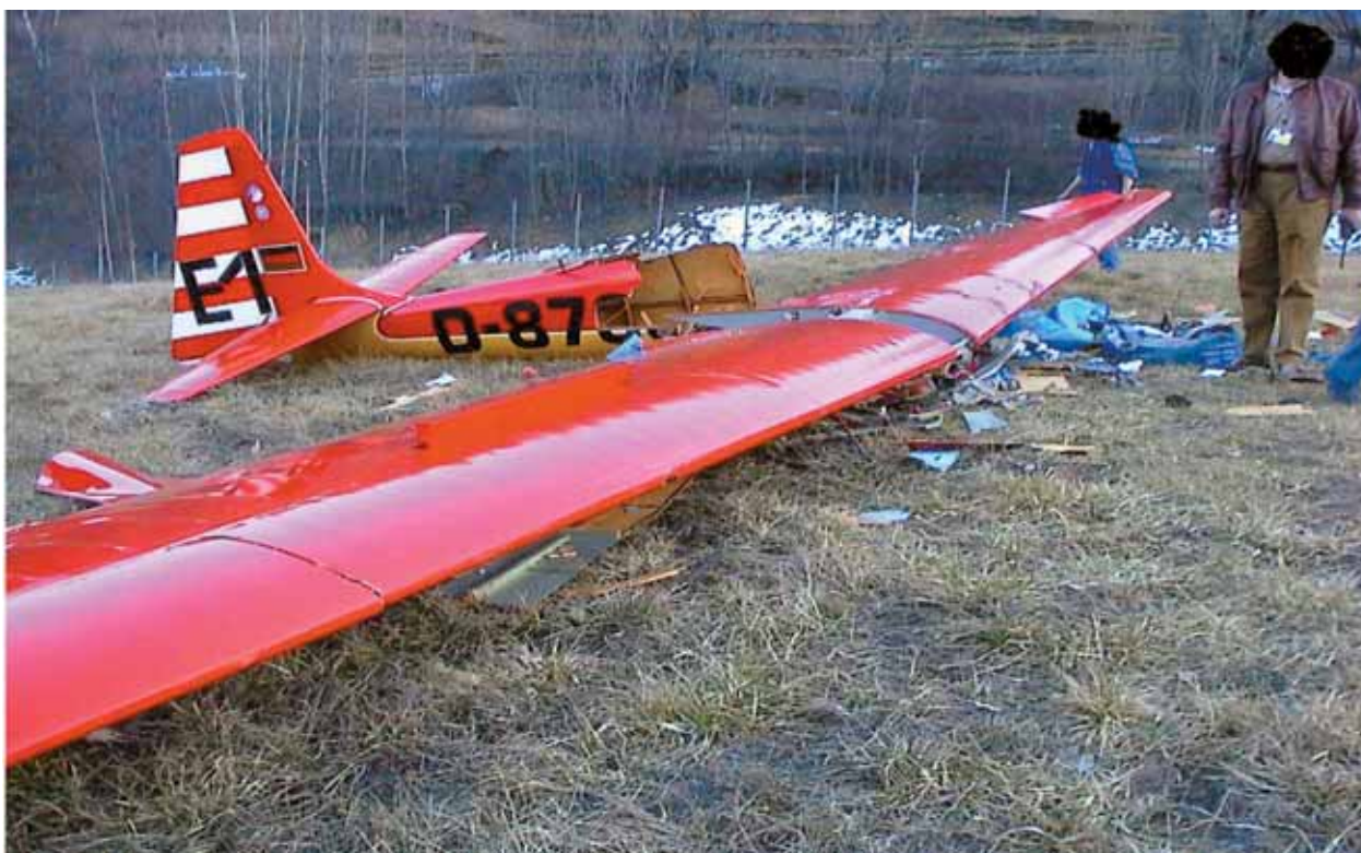
Parte anteriore della fusoliera e cabina di pilotaggio completamente distrutte.
