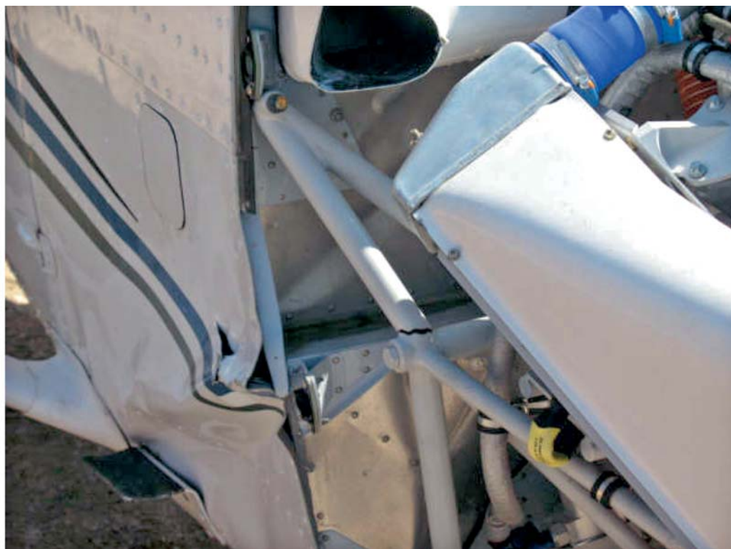
Particolare danni al castello motore.
