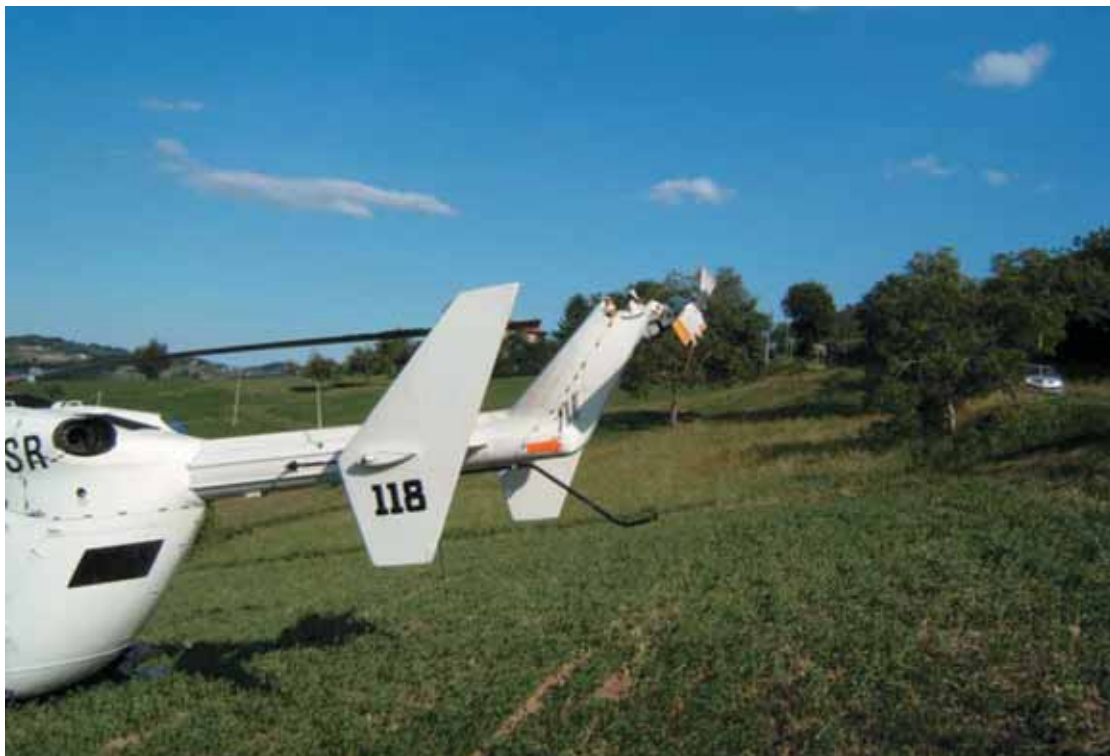
Particolare dei danni alla tail gearbox .
