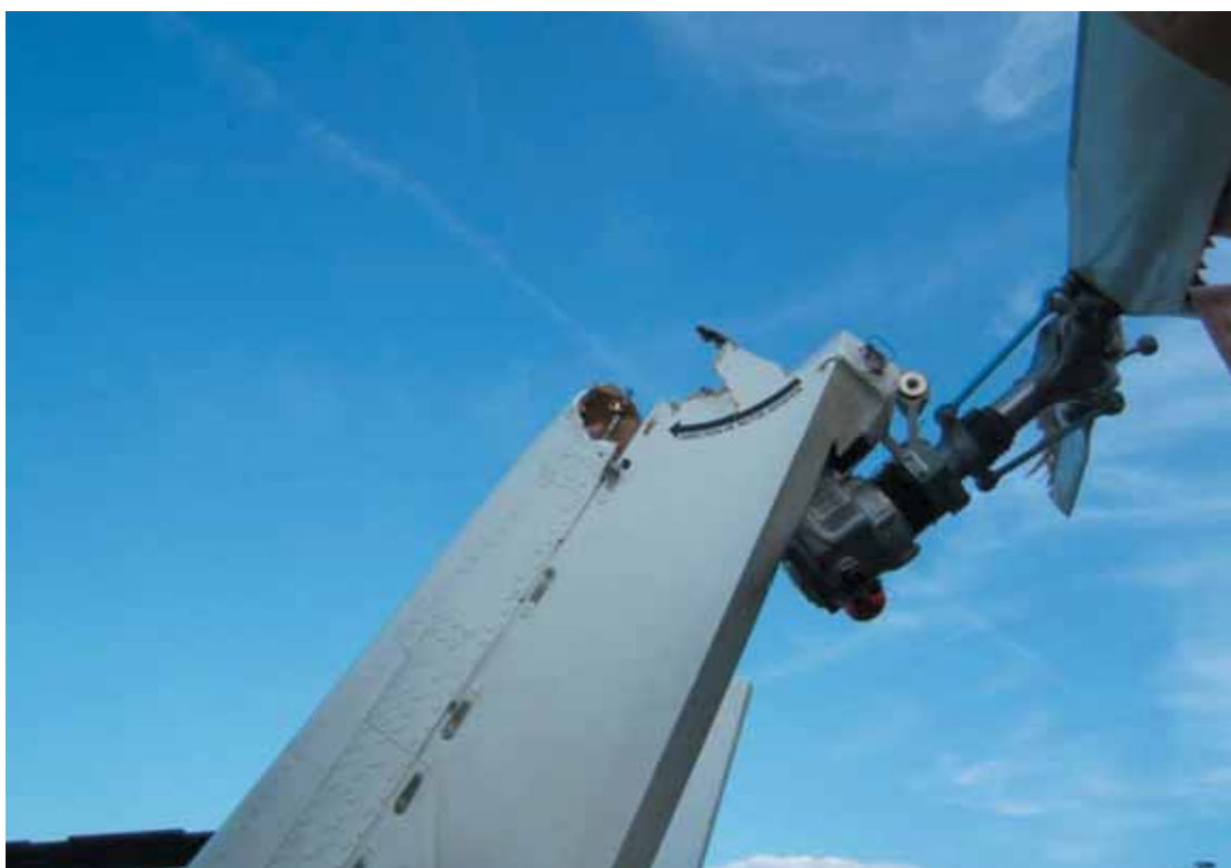
Particolare dei danni alla deriva verticale.
