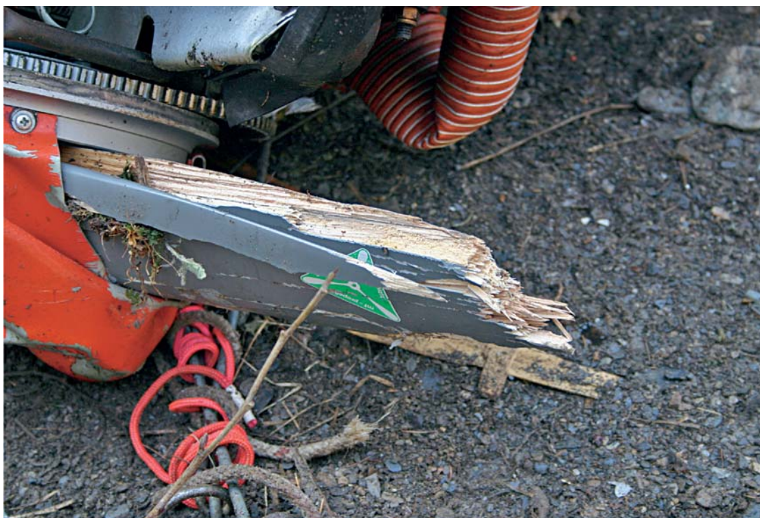
Dettaglio della rottura delle pale.
