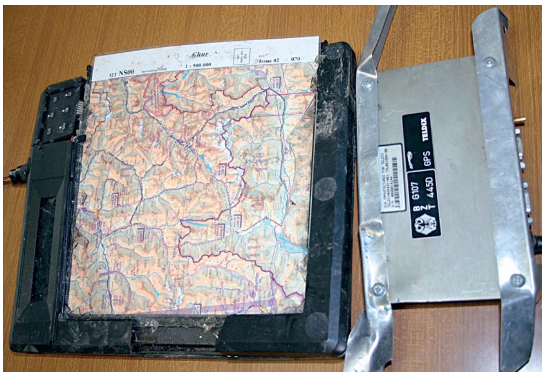
Sistema TELDIX (GPS e plotter cartografico).
