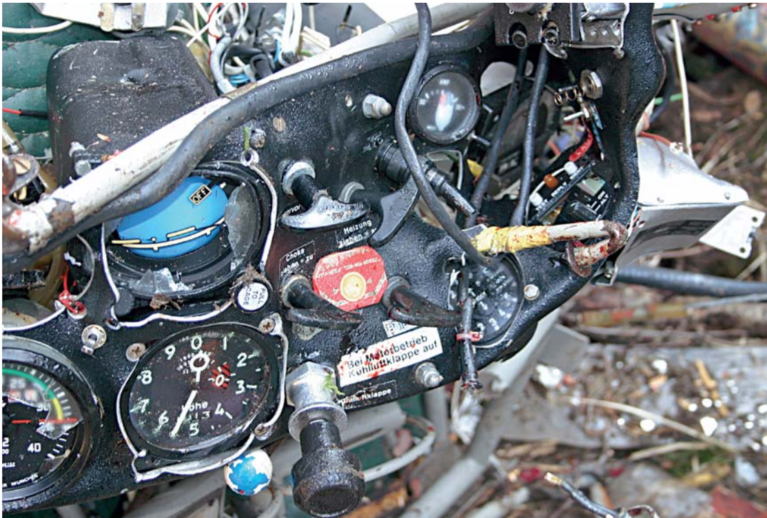
Comandi del motore, con manetta in posizione “tutto avanti”.
