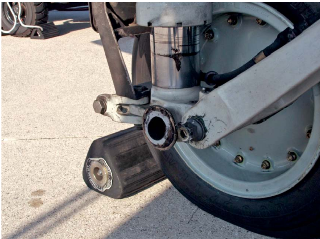
Particolare assale del ruotino anteriore.
