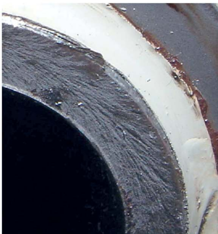
Figura 7 – Segni radiali di propagazione
