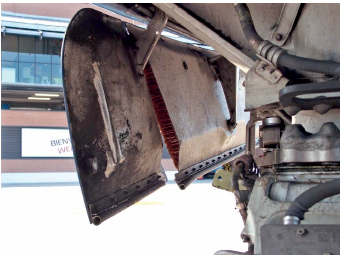
Particolare danni portello del carrello anteriore sinistro.
