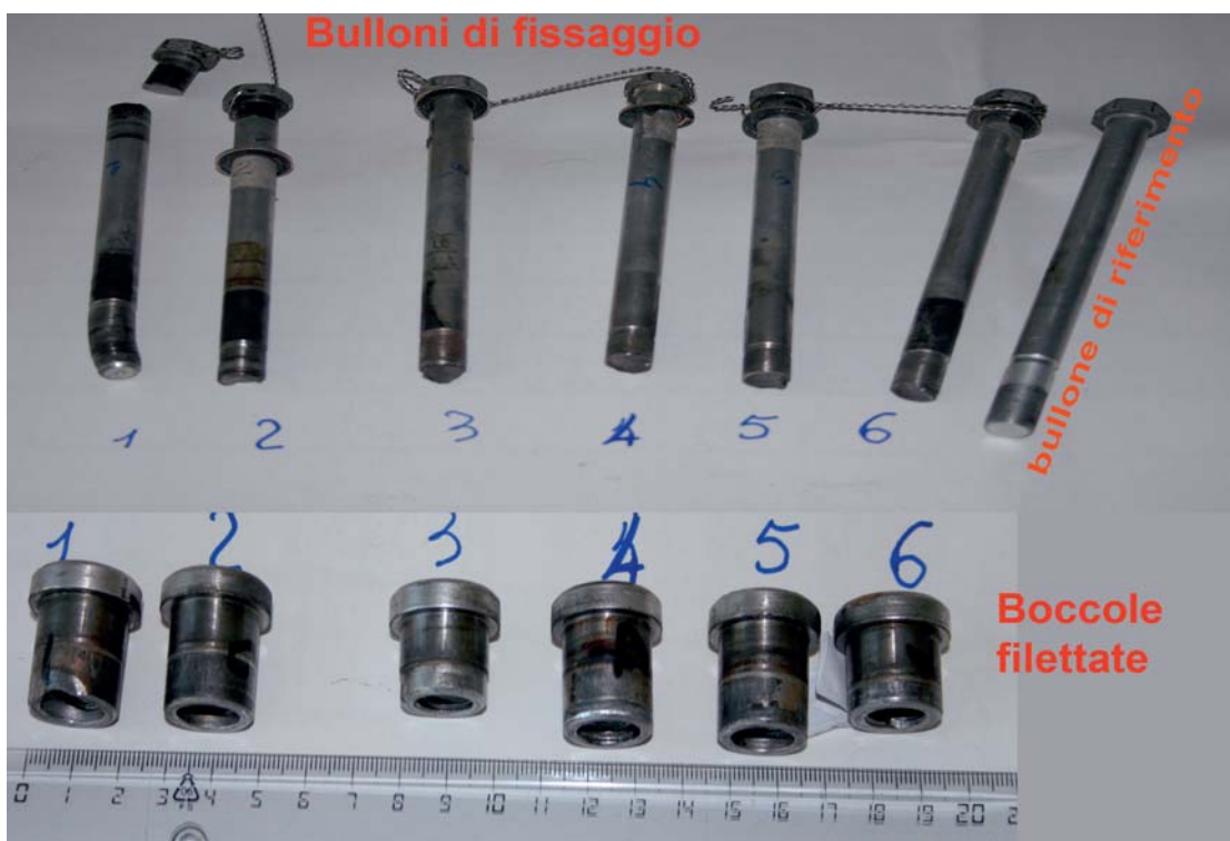
Bulloni di fissaggio elica e relative boccole di innesto.
