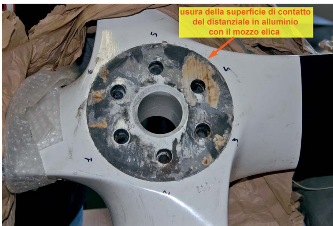
Mozzo elica-zona di contatto con il distanziale in alluminio.
