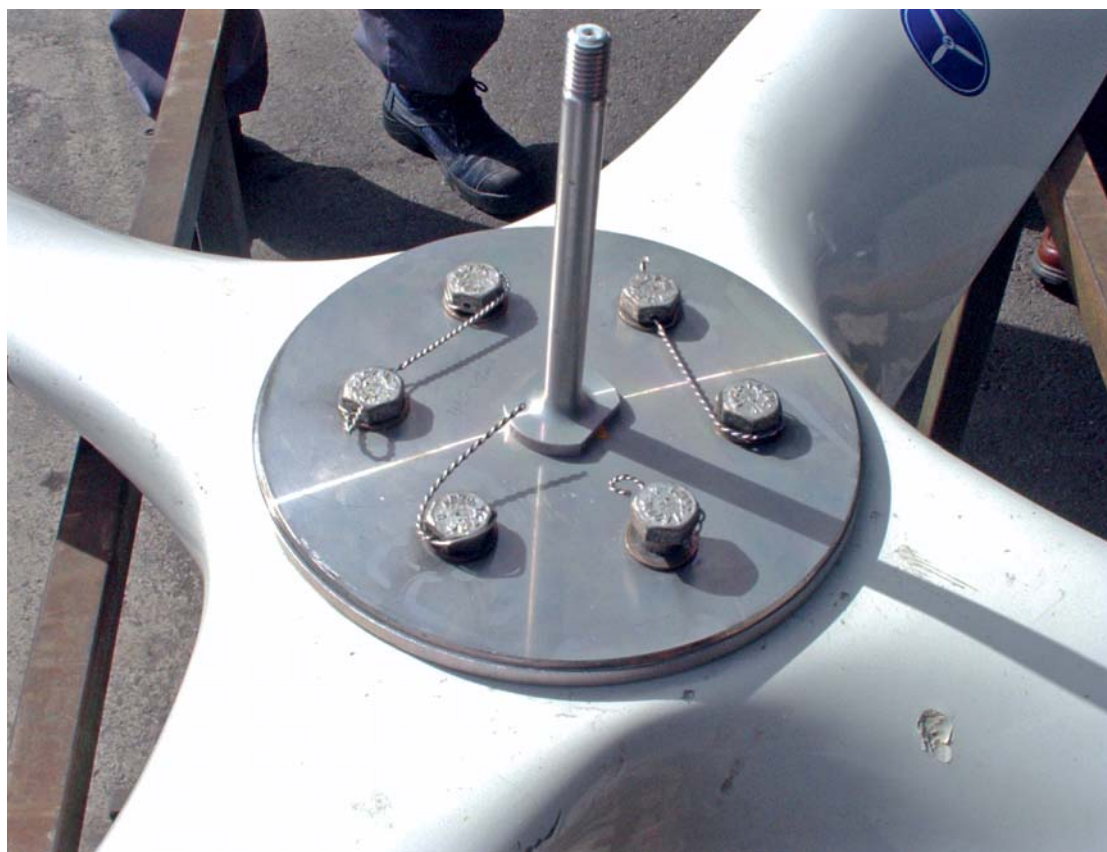
Piastra "portaogiva" con bulloni e frenature in sede dopo rimozione ogiva.
