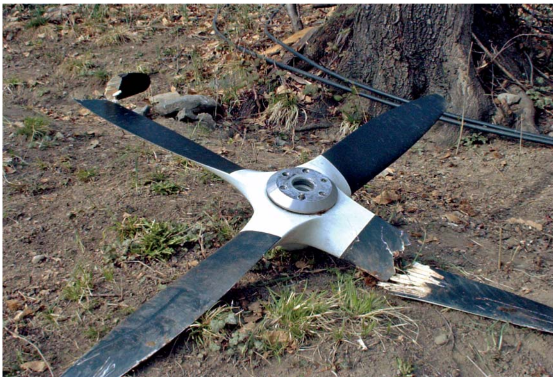
Elica estratta dal terreno e vista distanziale in alluminio.
