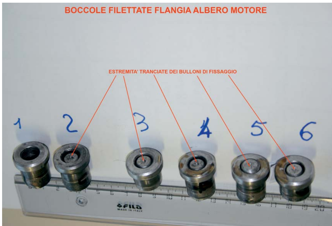
Boccole filettate rimosse dalla flangia albero motore.
