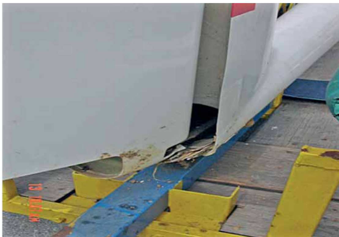
Danneggiamento parte inferiore (pattino) del timone di direzione.
