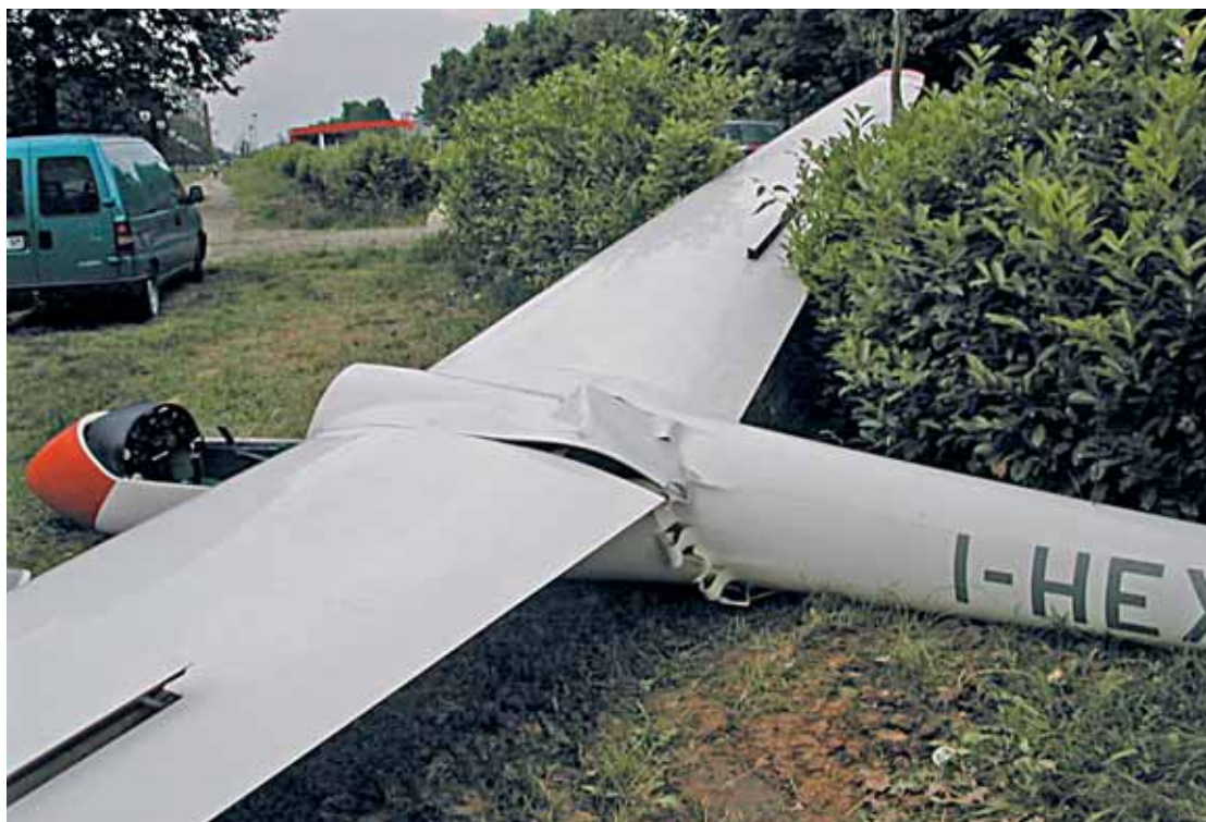
Danneggiamento della cellula, all'altezza dell'intersezione con il piano alare.
