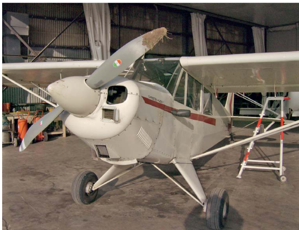
Aeromobile I-HHHH. Notare i danni alle estremità dell'elica.
