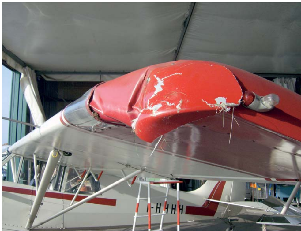
Aeromobile I-HHHH, particolare danni estremità semiala sinistra.
