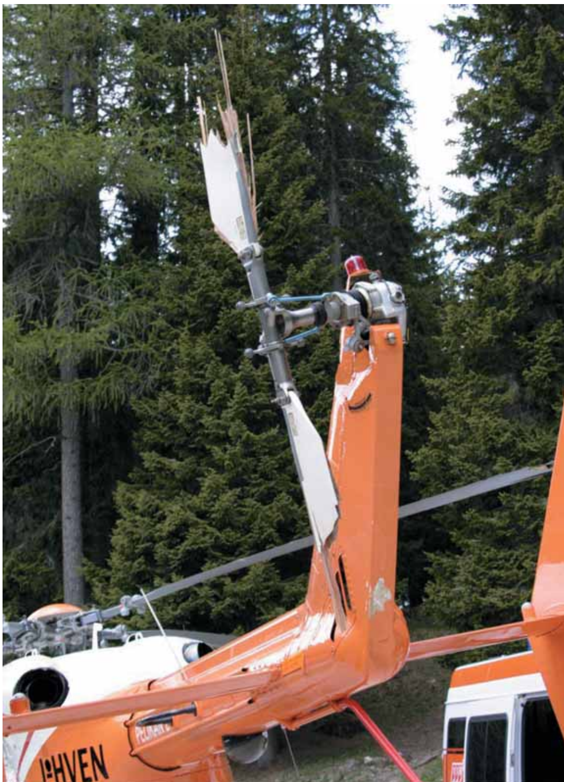
Danni al rotore di coda.
