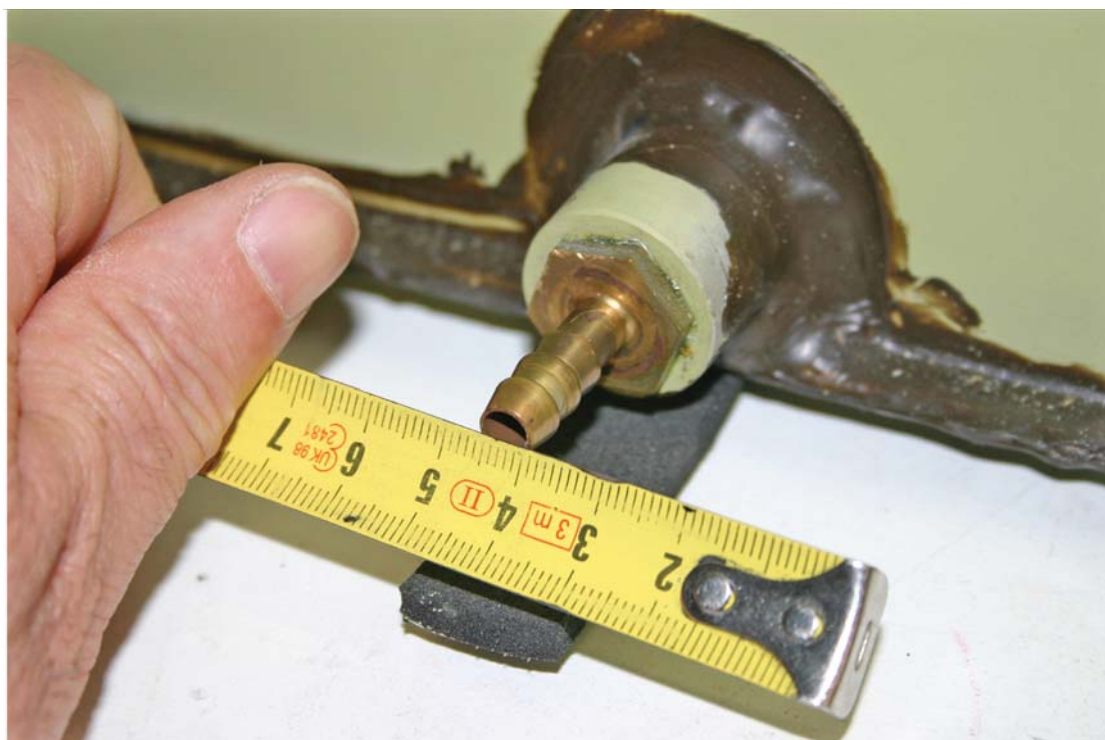
Diametro del bocchettone di uscita del serbatoio.
