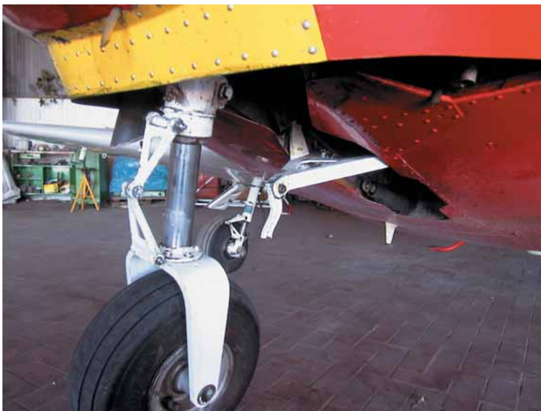
Particolare rottura carrello anteriore.
