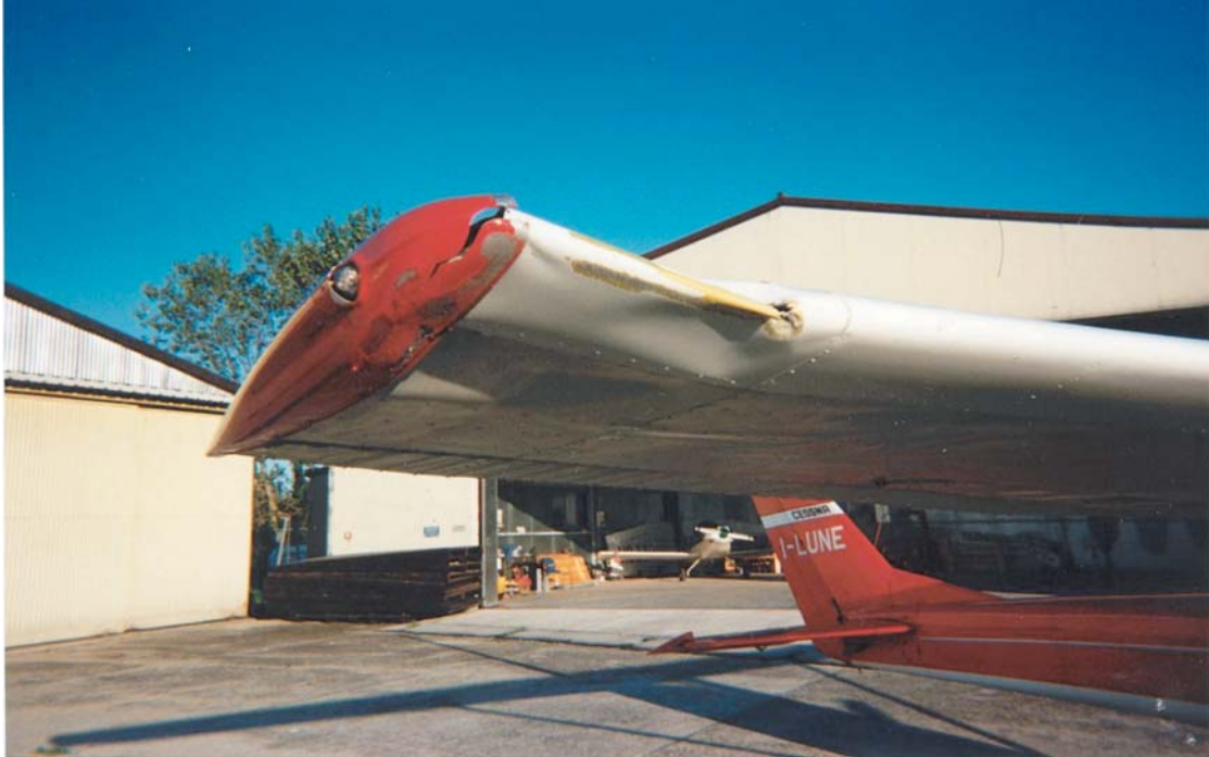
Danni all'estremità alare destra del Cessna 150.
