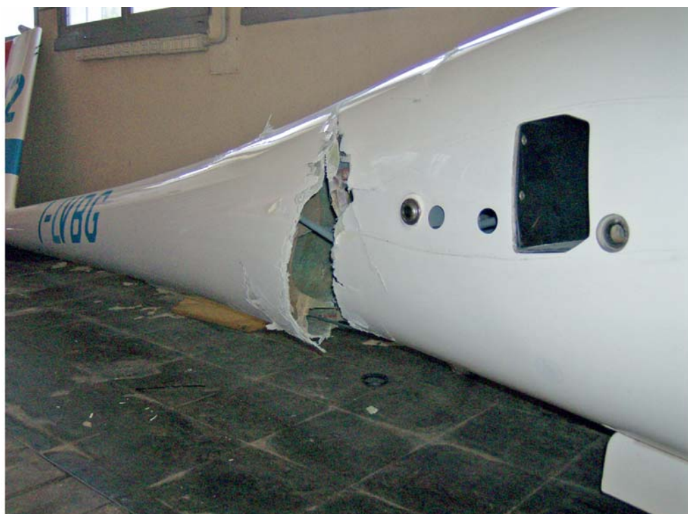
Particolare dei danni alla fusoliera, zona posteriore.
