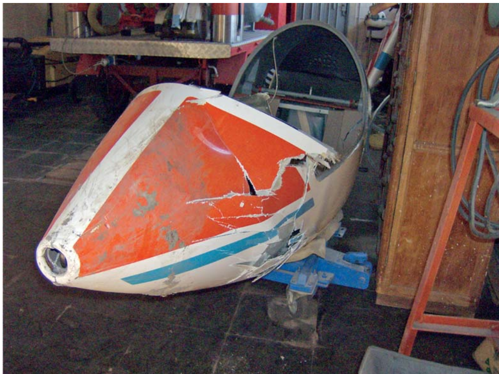
Parte anteriore della fusoliera. Sono evidenti i segni dell'impatto al suolo.
