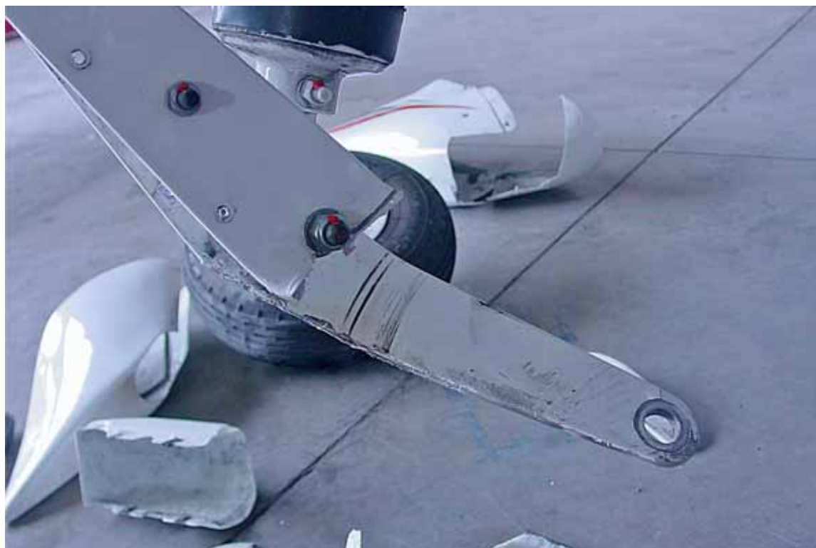
Forcelle gamba di forza carrello anteriore. Particolare della deformazione della forcella destra e rottura della forcella sinistra.
