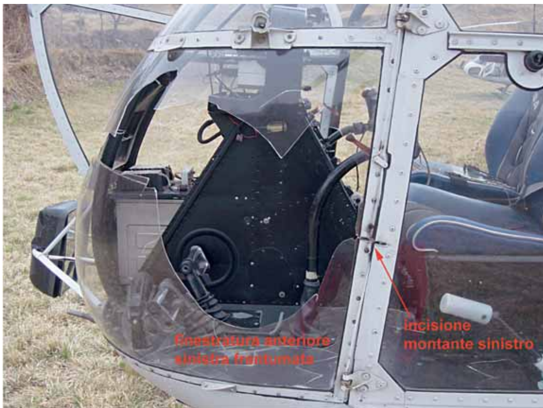
Parte anteriore sinistra danneggiata.
