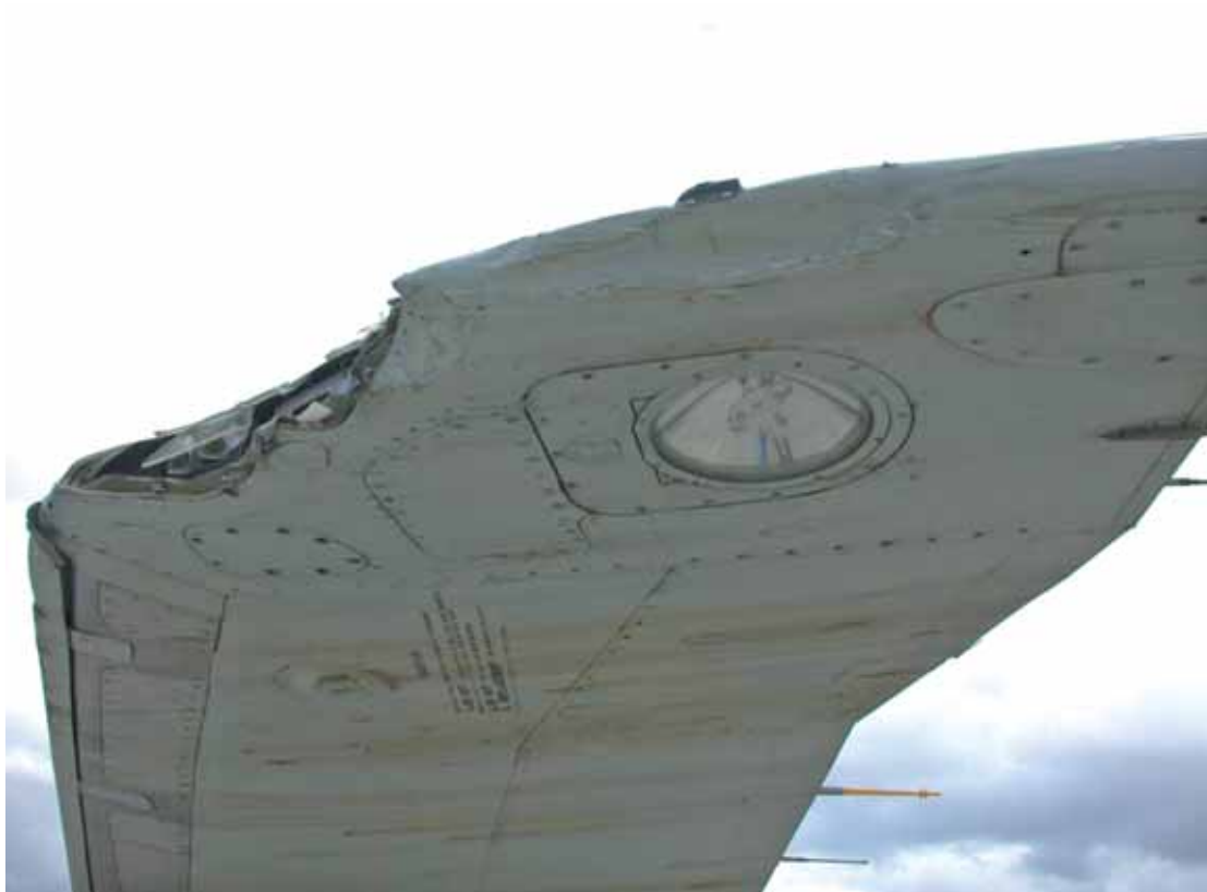
Danni alla semiala sinistra dell'aeromobile.
