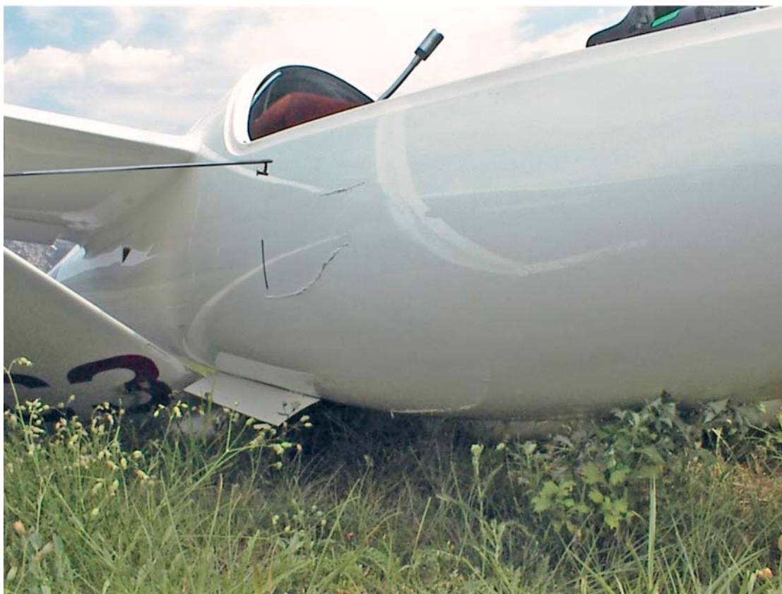
Danni riportati dall'I-ZOOW, principalmente a carico della fusoliera (parte anteriore).
