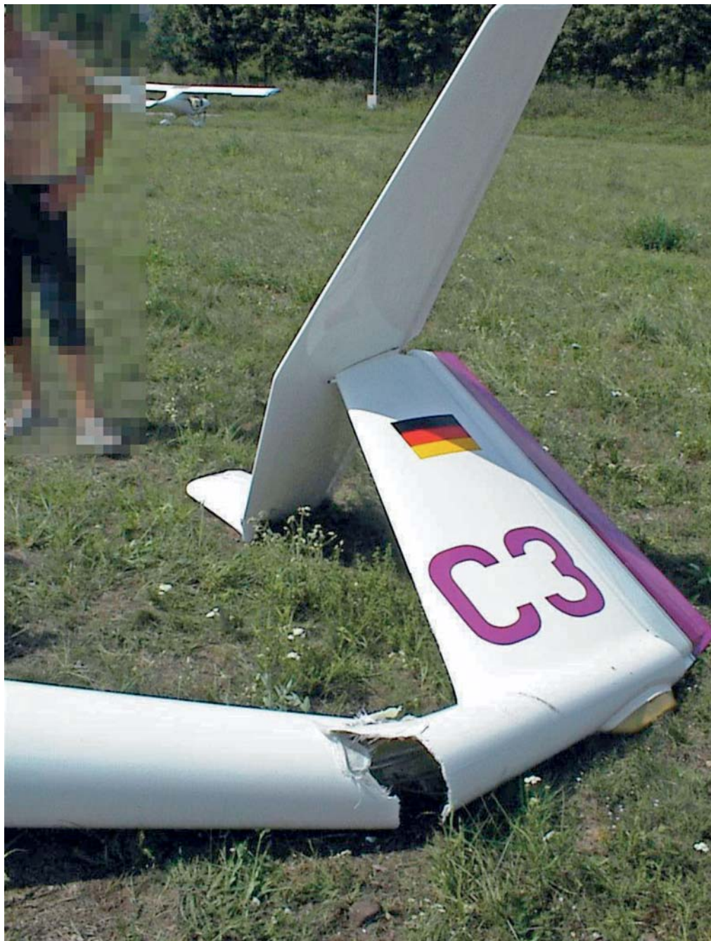
Aliante D-4643, particolare della rottura della fusoliera.
