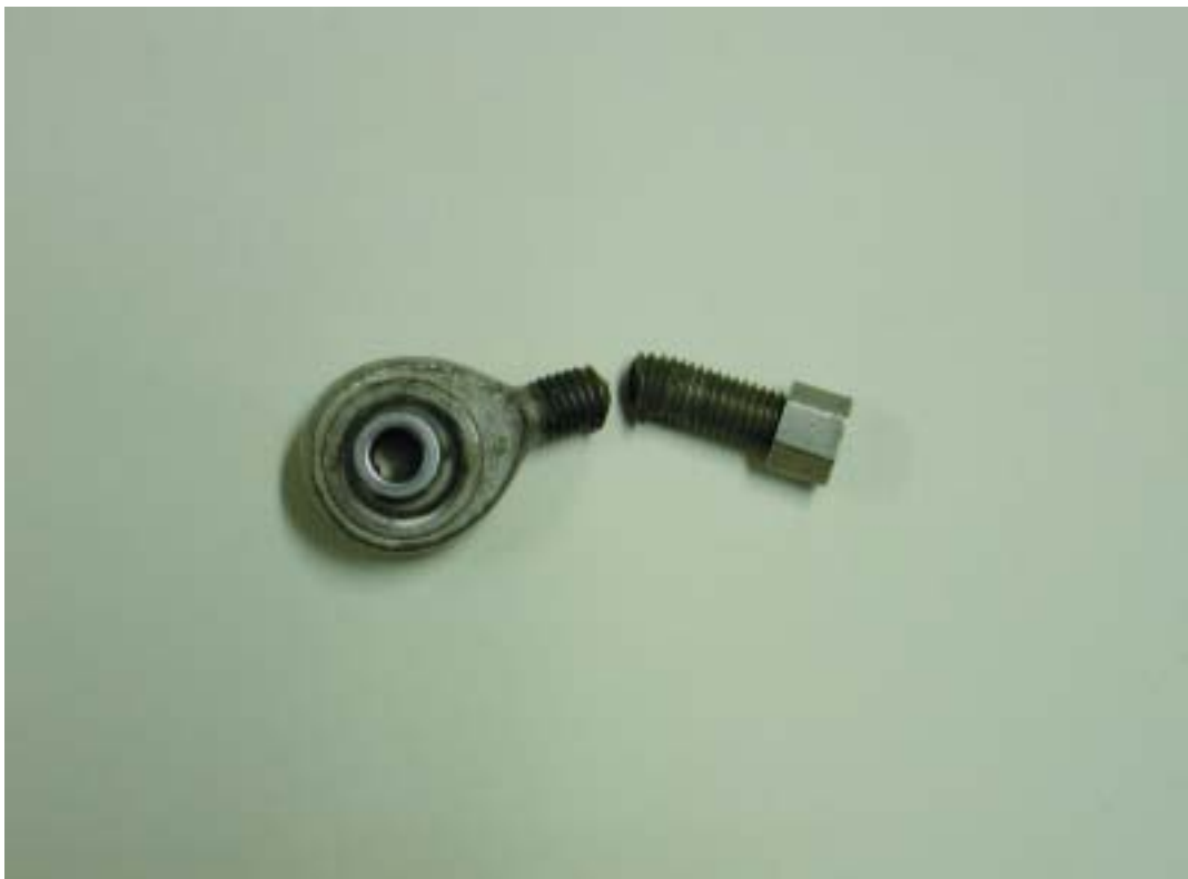
Rod End Bearing P/N 452729 dell'attuatore carrello anteriore rotto per sovraccarico di flessione.
