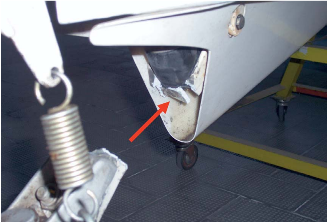
Punto di rottura.
