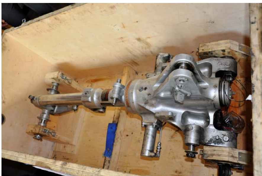
Foto 5: la gamba del carrello anteriore prima dell'esame condotto presso il costruttore del componente.
