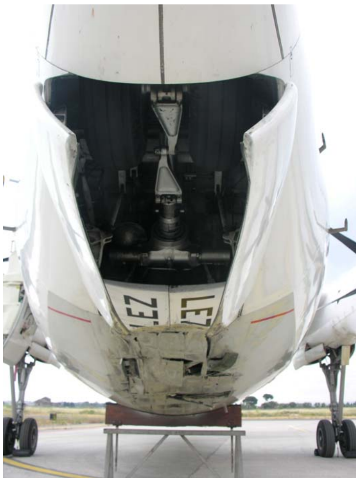
Foto 4: posizione di rinvenimento del carrello anteriore dopo la rimozione del velivolo dalla pista.
