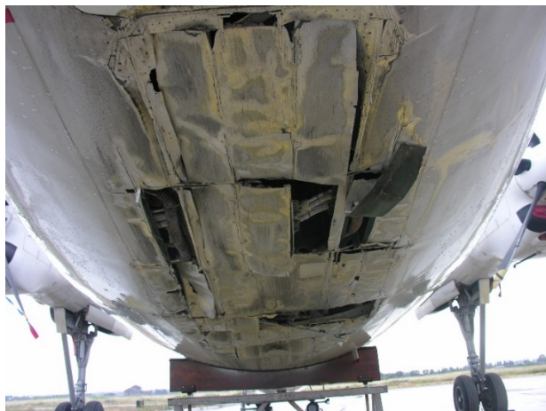
Foto 2: danni alla parte inferiore della fusoliera.
