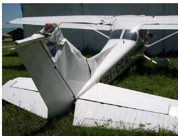
Foto 3: danneggiamenti impennaggio verticale.
