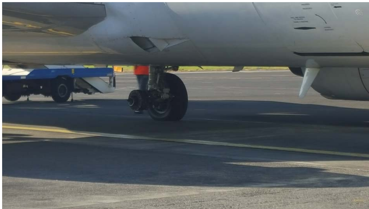
B737 EI-IGS: nella foto si può notare la ruota mancante.
