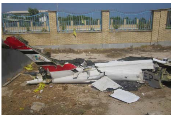
Agusta A109E EP-TRK: trave di coda (foto a sinistra); fusoliera e rotore principale (foto a destra).
