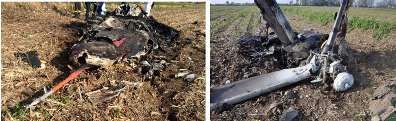
Alcune delle parti più significative del relitto dell’AW609: a sinistra il muso, a destra uno dei rotori.
