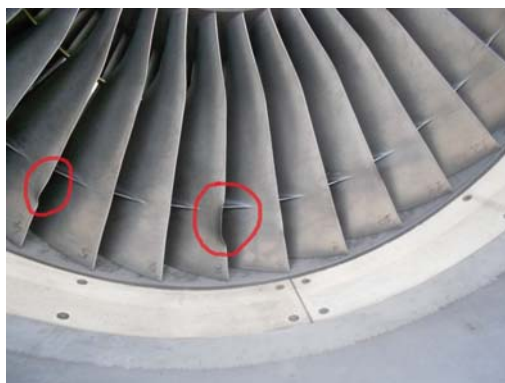
Evidenziati dai cerchi rossi i danni riportati da un motore a seguito di birdstrike .
