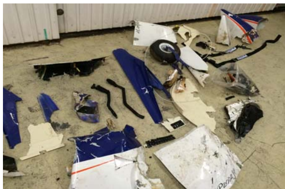
Tecnam P2002-JF TF-IFC: fusoliera e semiala sinistra (foto a sinistra); particolari della fusoliera e carrello anteriore (foto a destra).
