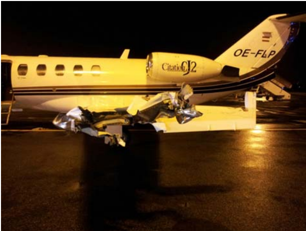
A sinistra, l'OE-FLP con i danni alla semiala sinistra. A destra, il trattore che ha urtato il velivolo.
