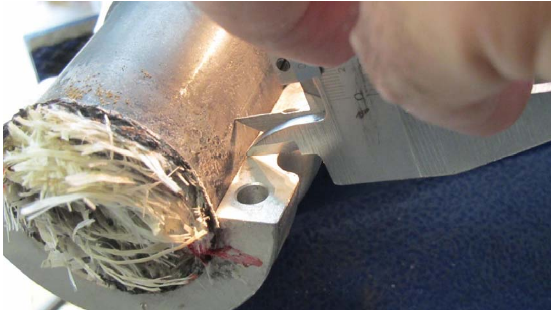
OK-LAU: controllo passo dell'elica effettuato nei laboratori dell'ANSV.
