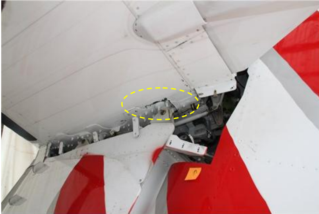
Parte dei danneggiamenti strutturali riscontrati sul VH-FVR.
