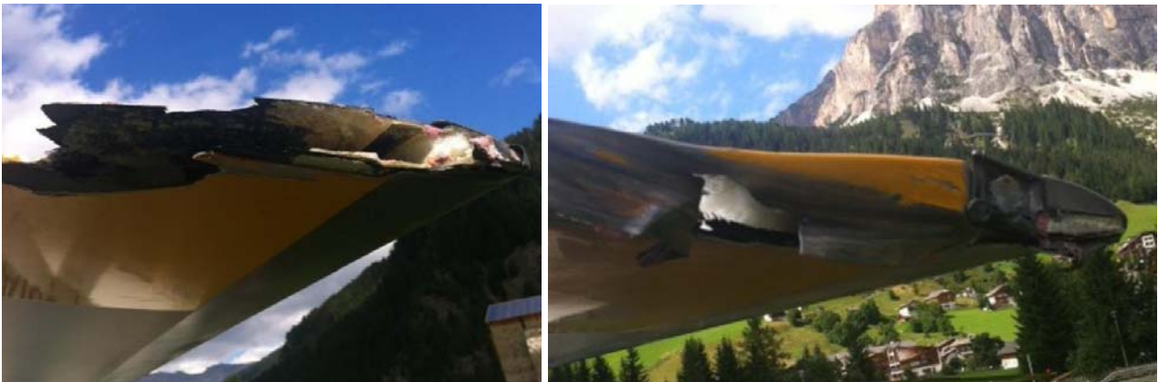
I-AICO: parte dei danneggiamenti strutturali riscontrati sulle pale del rotore principale.
