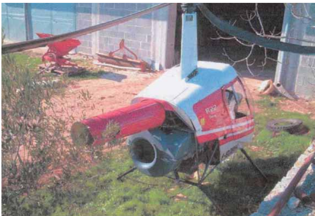
Particolare della trave di coda spezzata.
