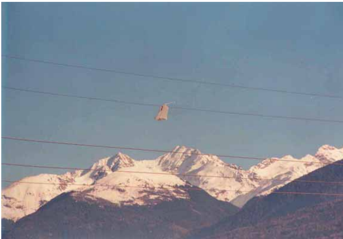
Particolare del piano di coda verticale inferiore, rimasto impigliato nel cavo elettrico.
