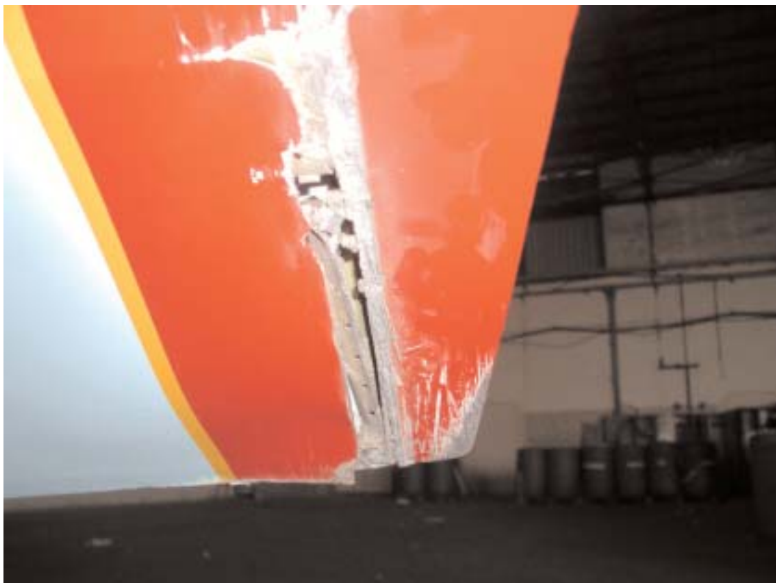
Particolare dell'alettone danneggiato
