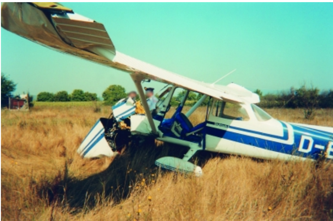
Foto del relitto: si notino i danneggiamenti alla semiala sinistra.
