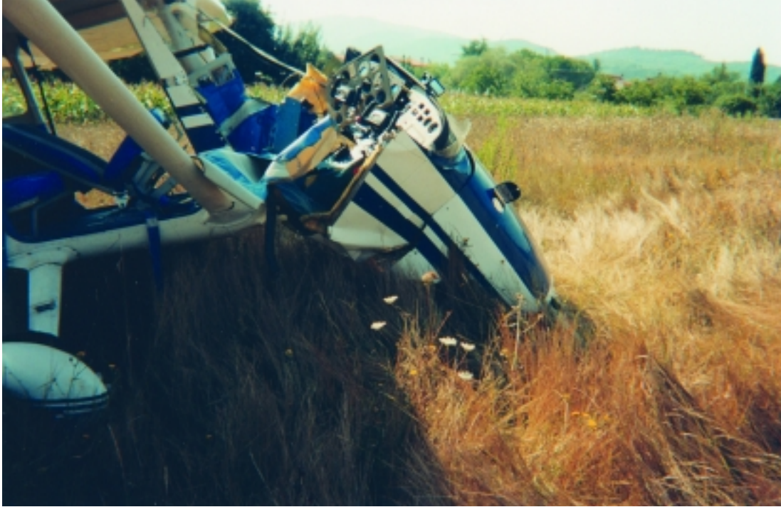
Foto del relitto: si notino i danneggiamenti della parte anteriore dell'aeromobile e del pannello strumenti.
