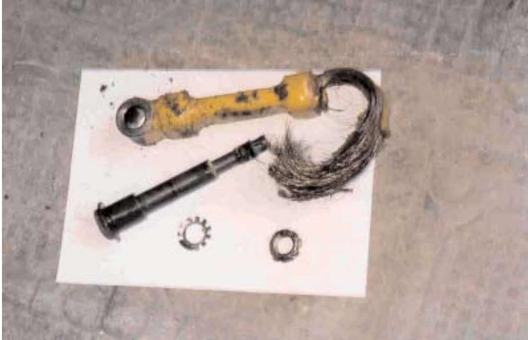
Particolare barra di torsione dopo lo smontaggio dal mozzo del rotore principale
