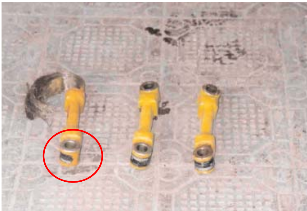
Le tre barre di torsione del mozzo dopo lo smontaggio dal corpo rotore. Notare la parte di etichetta nera adesiva parzialmente asportata sulla barra rotta
