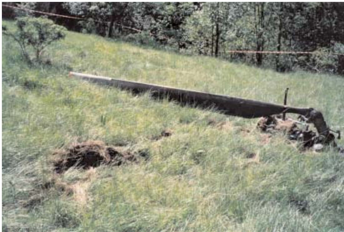
Corpo rotore principale – particolare segni impatto al suolo
