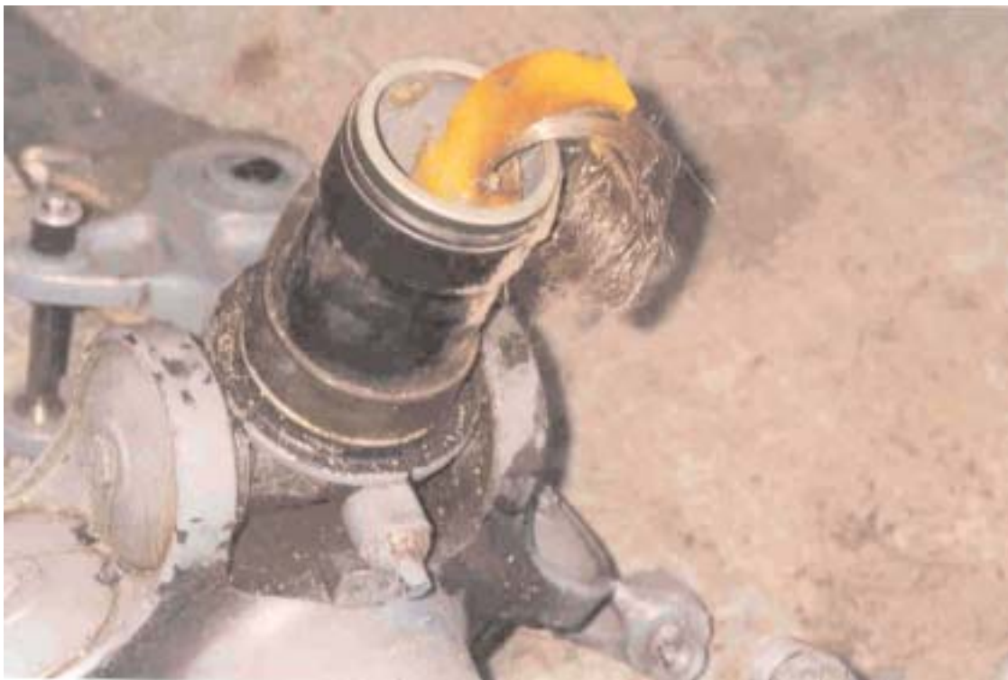
Particolare mozzo rotore principale con la barra di torsione che ha ceduto
