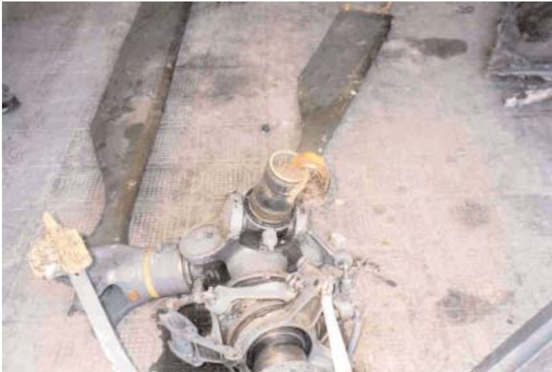
Corpo rotore principale. Notare la mancanza della terza pala con la barra di torsione rotta nel mozzo
