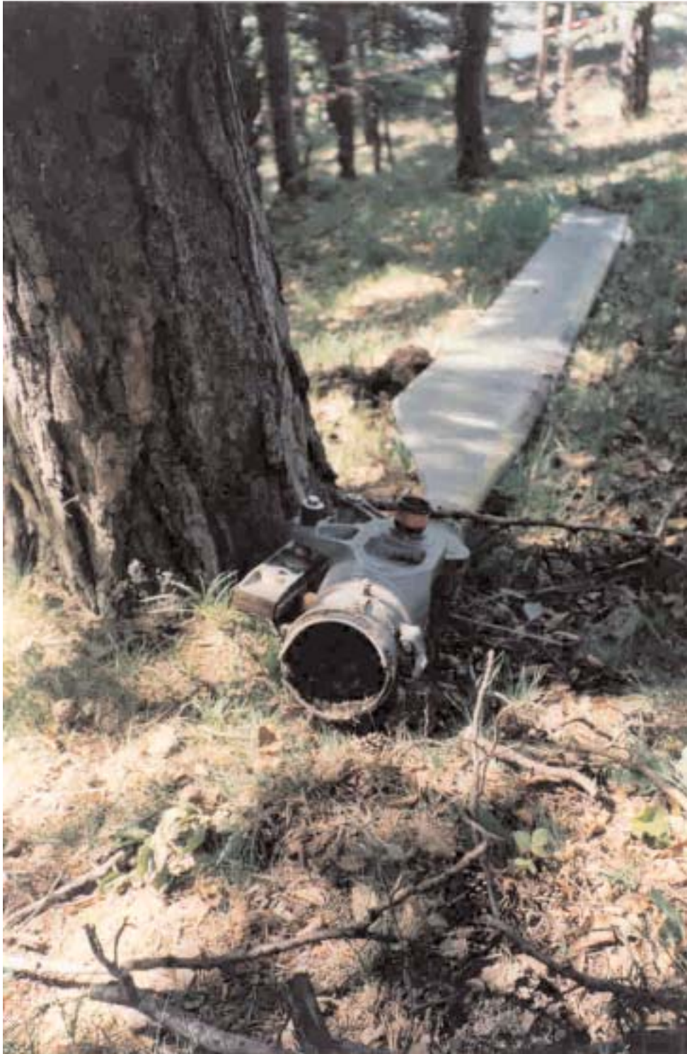
Pala staccatasi in volo dall'elicottero e ritrovata nel bosco antistante il luogo dell'incidente ad una distanza di circa 100 - 120 metri dal relitto
