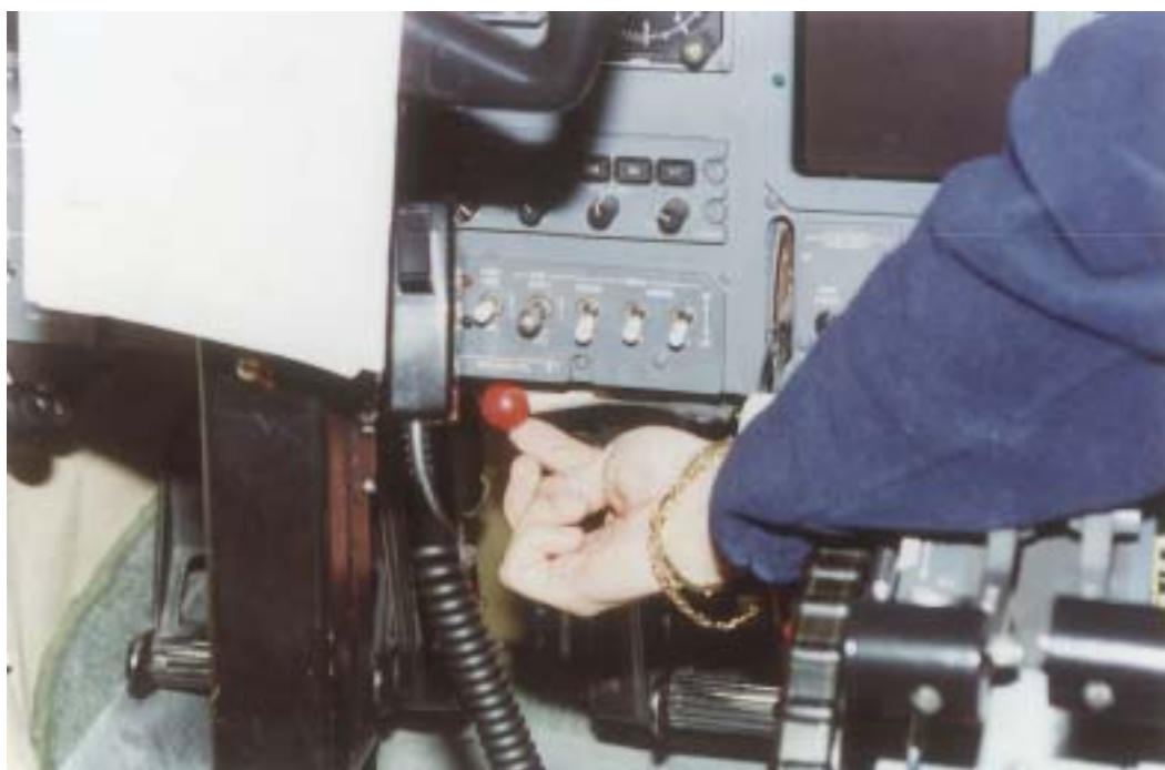
Particolare della leva del freno di emergenza
