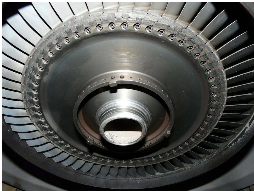
Foto 11: segni di interferenza tra turbina generatrice di gas e turbina di potenza.
