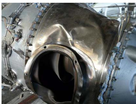
Foto 9: vista del motore prima dello smontaggio. Foto 10: deformazioni a compressione sul lato destro.
