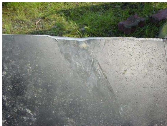
Foto 8: usura da scorrimento su una pala dell'elica.
