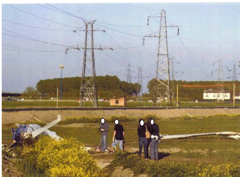
Foto 5: a sinistra della foto il relitto del D-EPOE, sulla destra la semiala sinistra.
