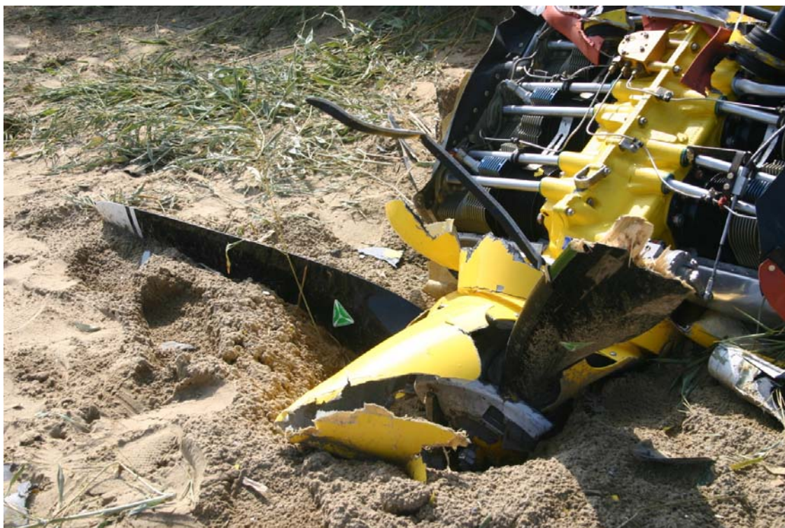
Foto 4: primo piano del complessivo elica-motore e punto di primo impatto.
