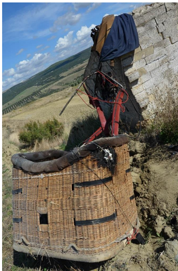
Foto 2: la cesta dell'aeromobile con evidenti segni di bruciatura.
