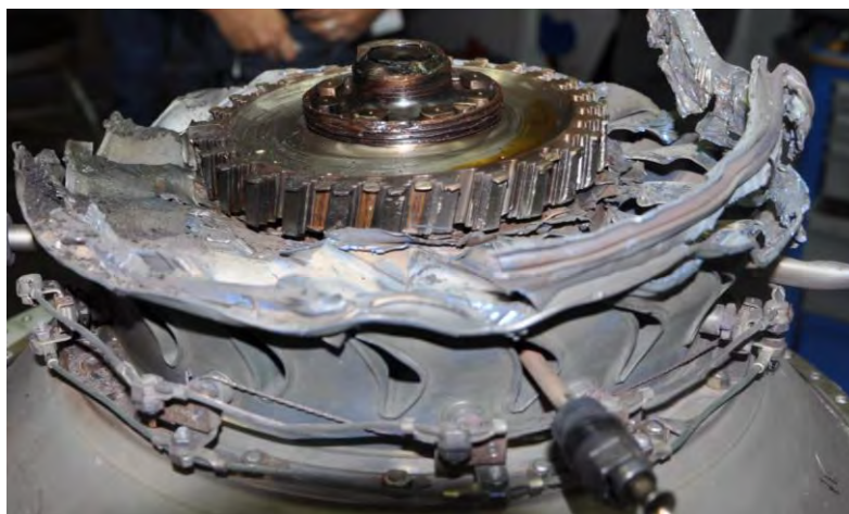
Foto 36: la power turbine con porzione di PT shaft e vista del NGVR con il danneggiamento provocato dal PT disk .
