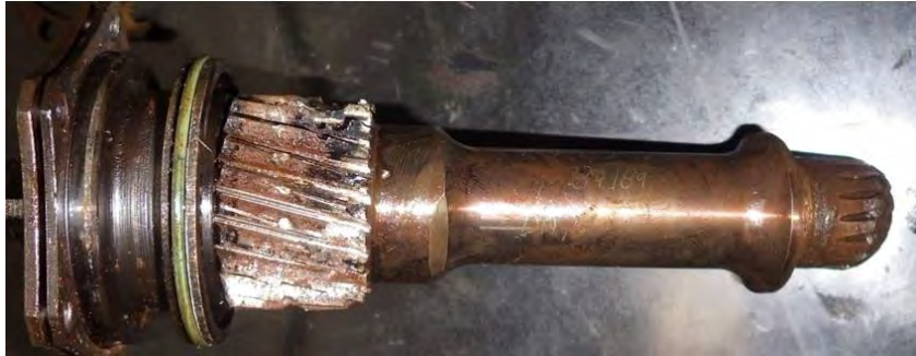
Foto 28: quill shaft fratturato in corrispondenza del millerighe.
