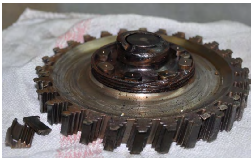
Foto 37: PT disk e porzione di PT shaft fratturata.
