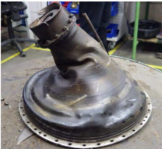
Foto 29: supporting cone vista esterna.
