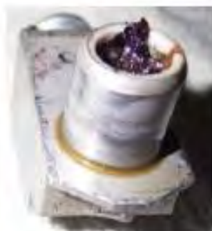
Foto 40: presenza di metallo sul chip detector della reduction gearbox e sul magnetic plug .
