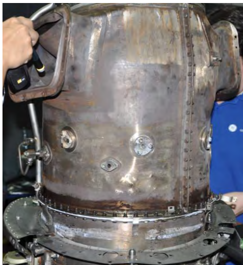
Foto 35: l' exhaust case assembly con le evidenti deformazioni.
