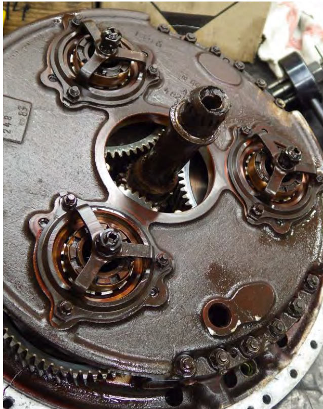
Foto 27: RGB rimossa dal motore con quill shaft fratturato in corrispondenza del millerighe.
