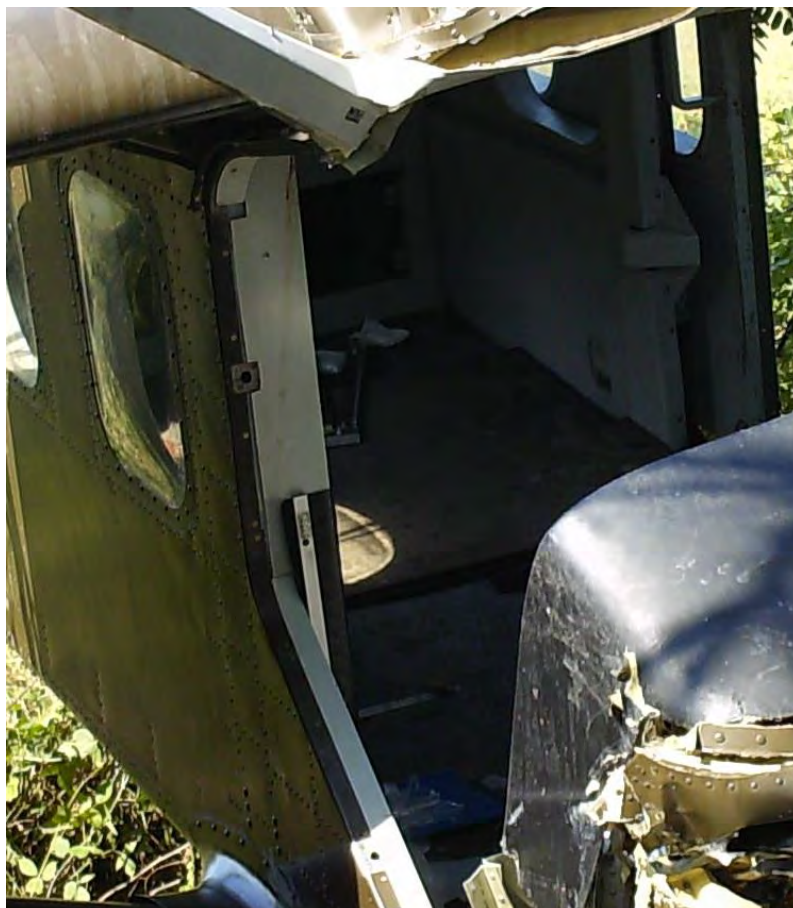
Foto 20: vista cabina passeggeri; notare l'assenza di cinture di sicurezza.
