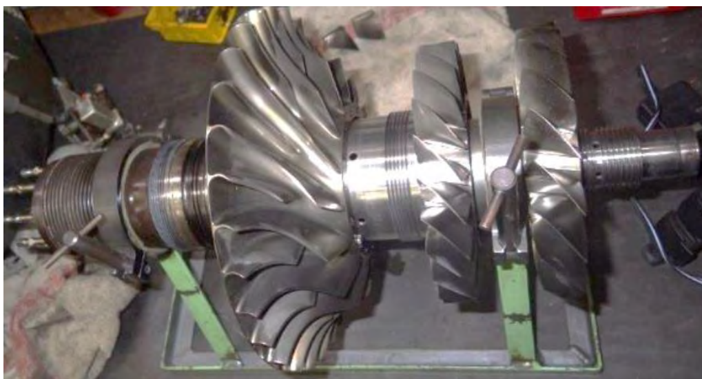
Foto 41: compressore del gas generator .
