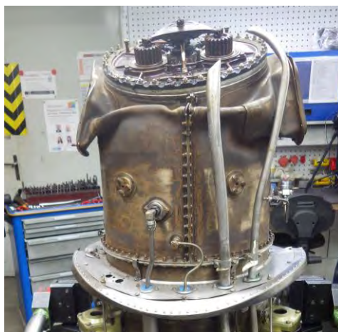
Foto 25: parte di RGB rimasta vincolata al motore.
