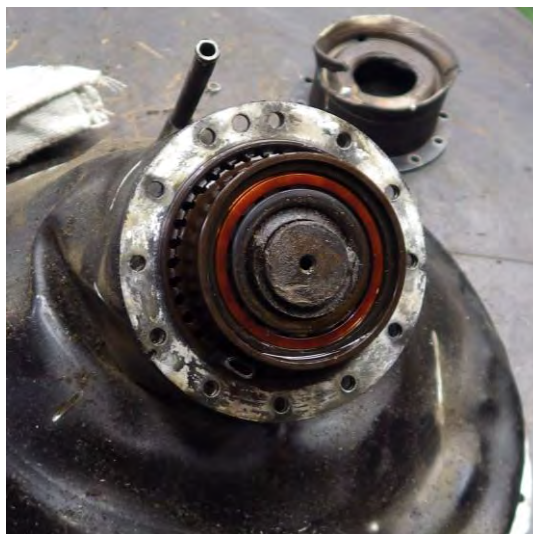
Foto 31: particolare della linea di rottura del PT shaft ; in centro, lo spessore dietro il quale è presente il quill shaft .
