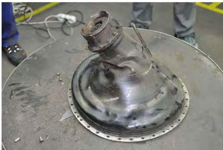
Foto 6: supporting cone con deformazione causata dall'impatto.
