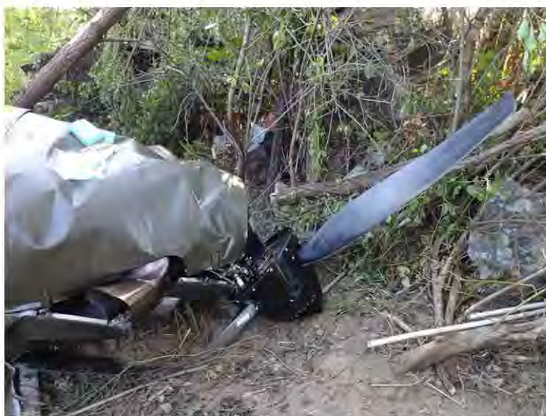
Foto 2: l'elica con danni compatibili con un regime di rotazione nullo.
