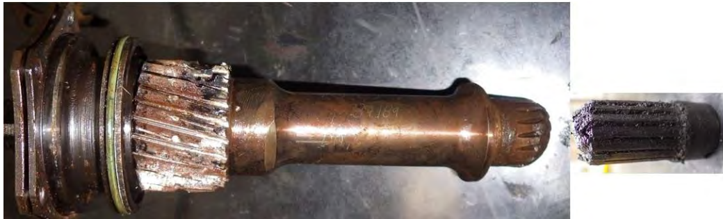
Foto 33 e 34: a sinistra il quill shaft fratturato; a destra la restante parte del quill shaft estratta dal PT shaft .
