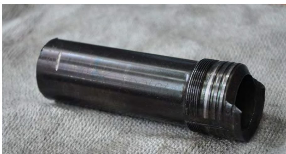
Foto 39: PT shaft , l'estremità destra è il punto di frattura (estremità sinistra tagliata per il disassemblaggio).
