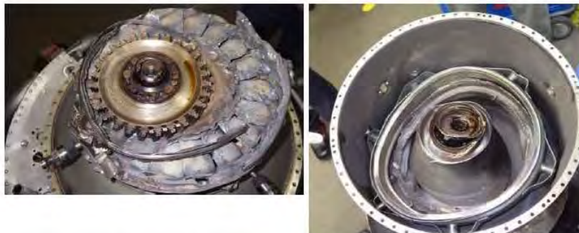
Foto 5: a sinistra, la power turbine separata dal PT shaft con parte dello stesso ancora vincolata; a destra, il supporting cone , al cui interno è visibile la sezione di PT shaft separatasi dalla power turbine .
