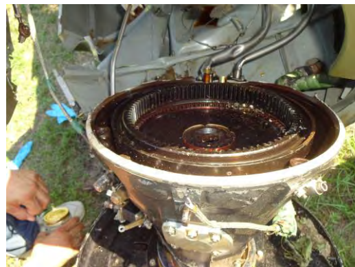
Foto 16: parte di RGB fratturata.
