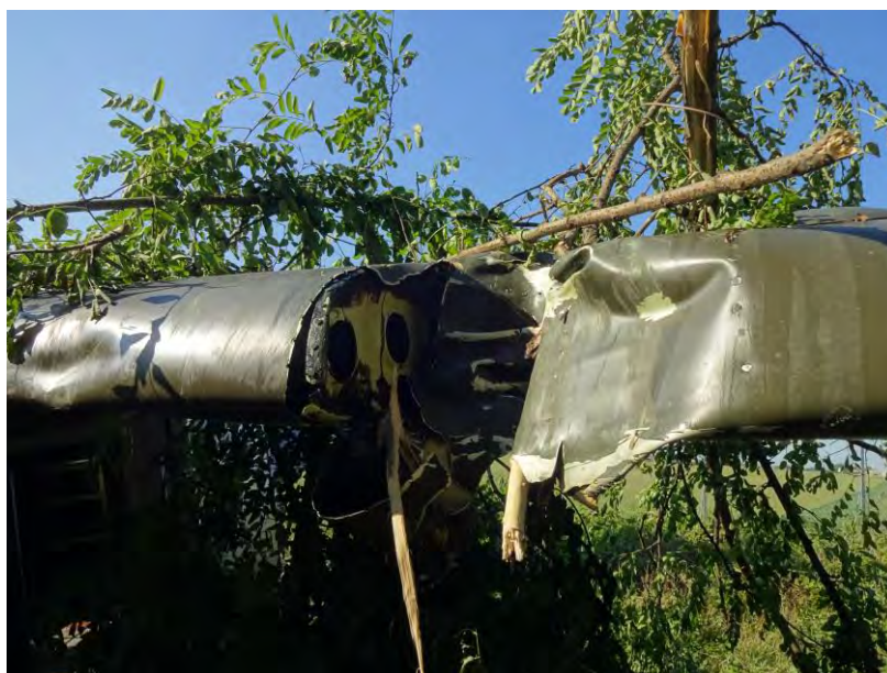
Foto 10: particolare del bordo d'attacco della semiala sinistra.
