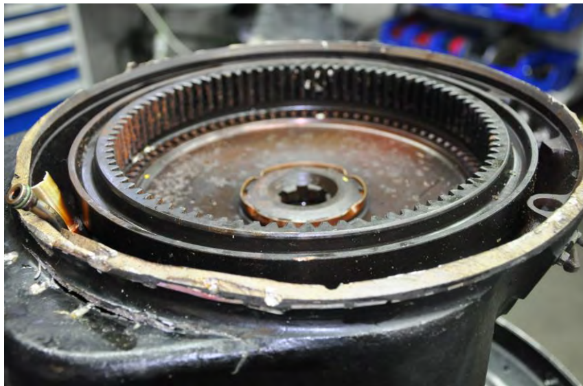
Foto 24: particolare sezione riduttore giri (RGB) rimasto solidale all'elica.
