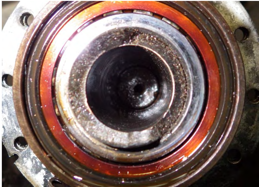
Foto 32: rimosso lo spacer è visibile il quill shaft .
