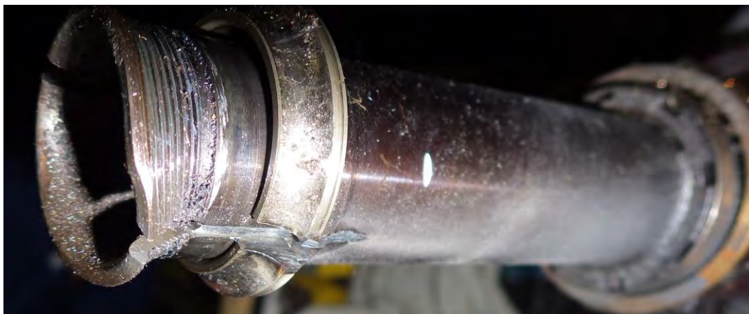
Foto 38: estremità del PT shaft ove si innesta il quill shaft (le incisioni sono dovute a tagli per disassemblaggio).
