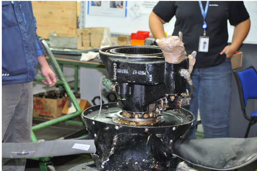
Foto 23: complessivo elica e porzione del riduttore giri (RGB).
