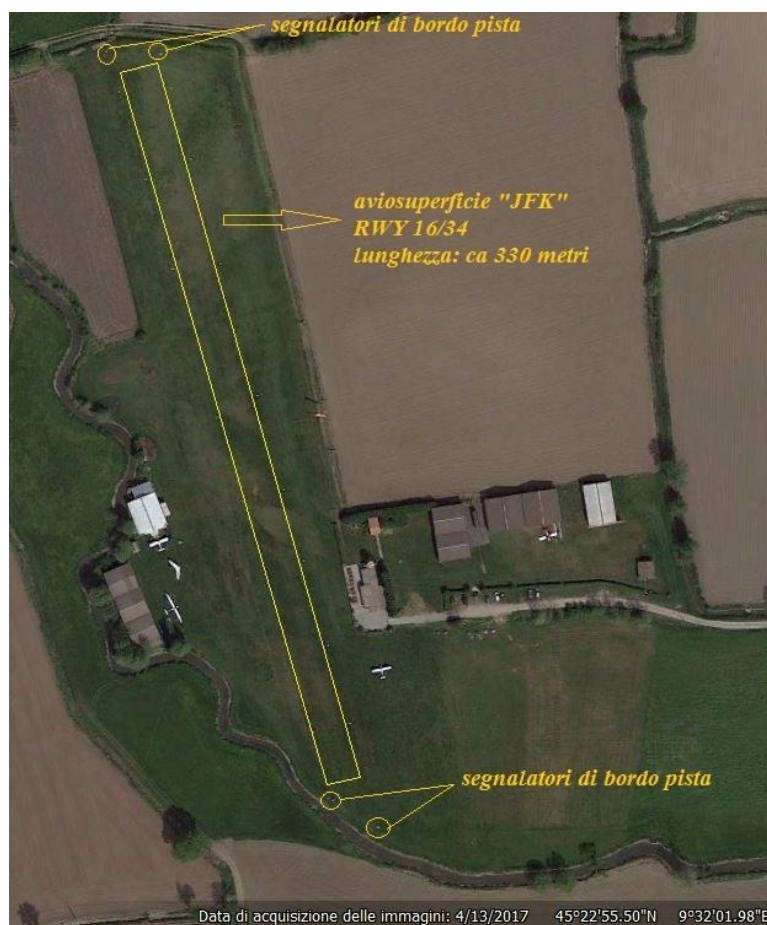
Figura 2: caratteristiche RWY 16/34 dell'aviosuperficie "JFK" (su supporto Google Earth).
