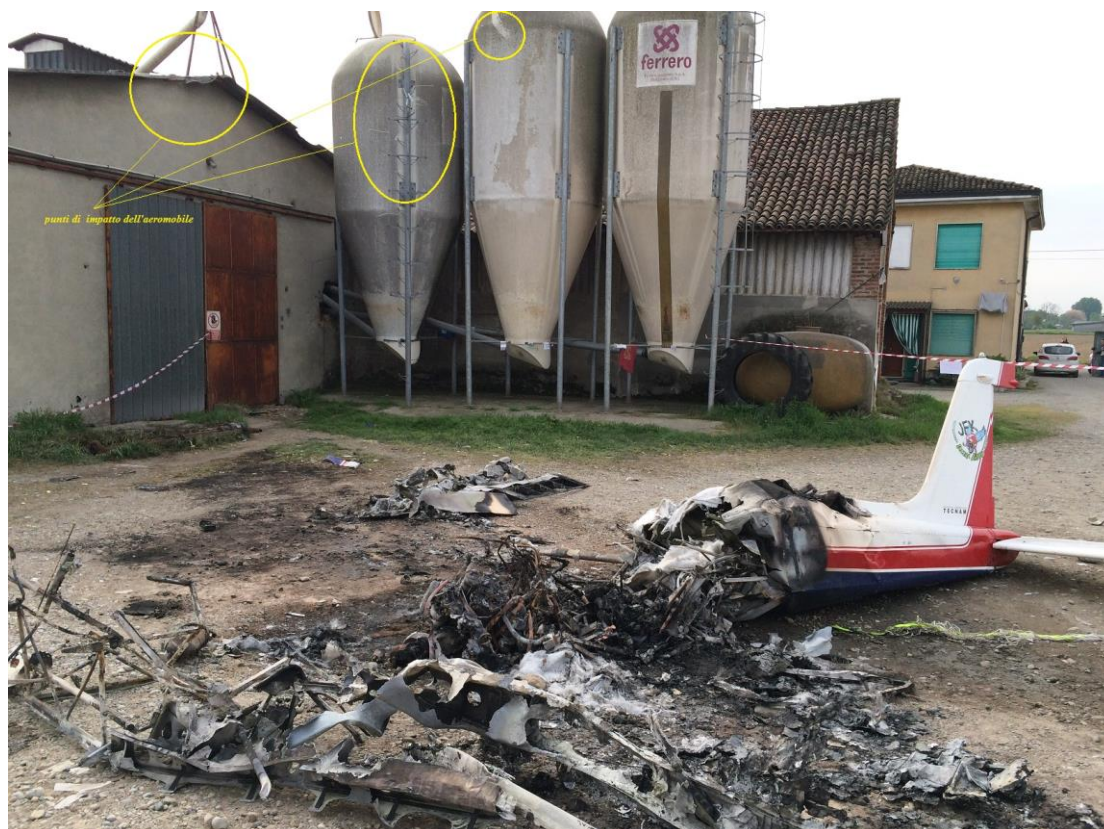
Foto 1: aeromobile I-7020 sul luogo dell'incidente e segni di impatto sulle strutture adiacenti.
