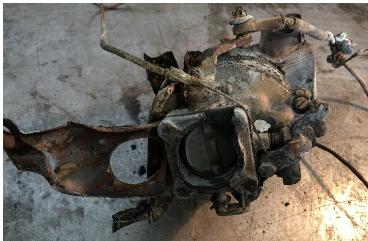
Foto 35: disassemblaggio del carburatore.
