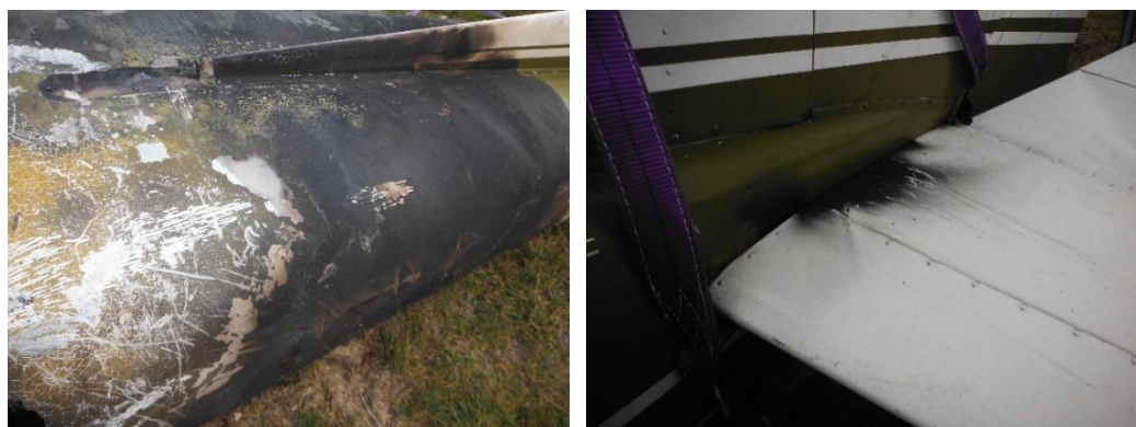
Foto 24 e 25: effetti del surriscaldamento della fusoliera e tracce di fuliggine fuoriuscita dai punti di attacco dello stabilizzatore.
