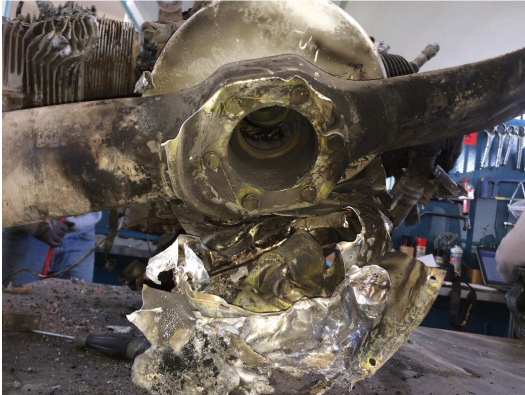
Foto 33: particolare dei dadi di fissaggio dell'elica.
