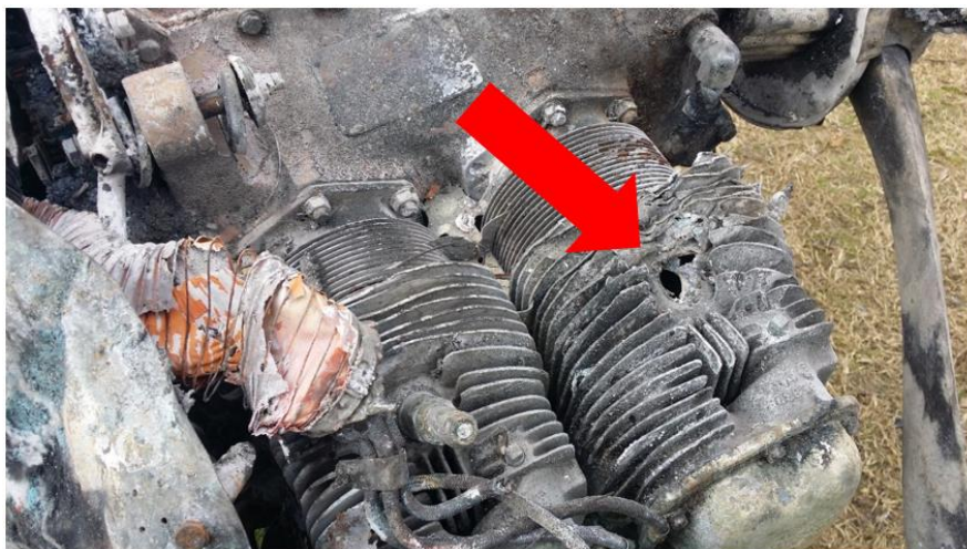
Foto 14: dettaglio della candela mancante.
