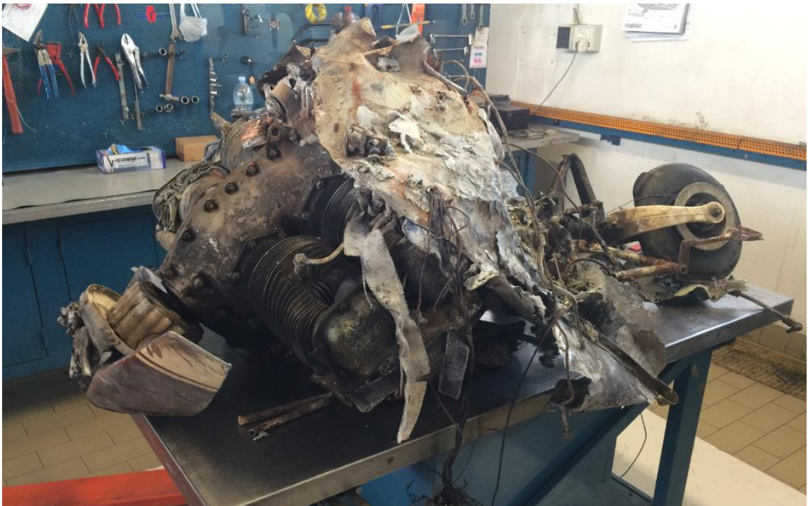
Foto 32: gruppo elica, propulsore e carrello anteriore prima dell'analisi tecnica.
