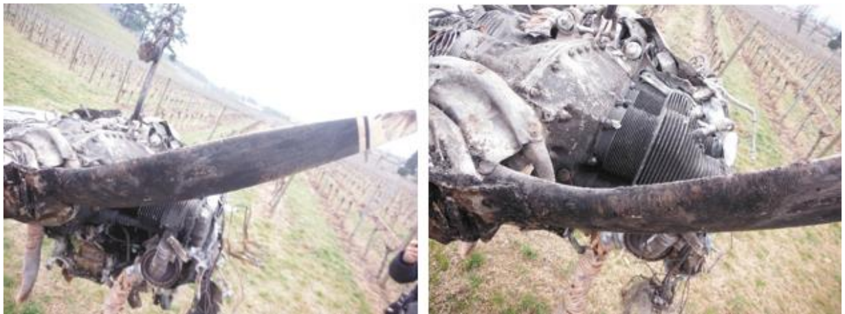
Foto 21 e 22: dettaglio delle deformazioni delle pale dell'elica.
