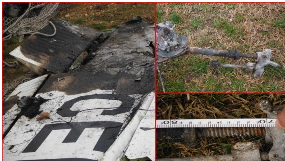
Foto 29: posizione dei flap sul relitto e misurazione dell'asta dell'attuatore ritrovata sul luogo dell'incidente.
