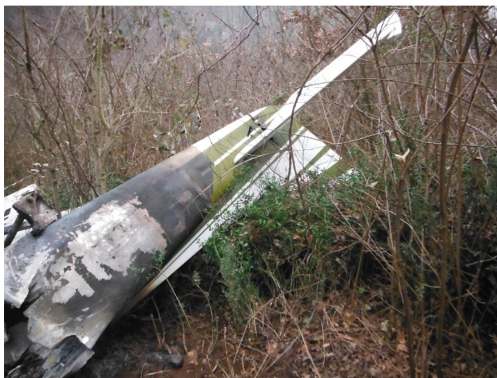
Foto 9: dettaglio della parte posteriore della fusoliera e dei piani di coda.
