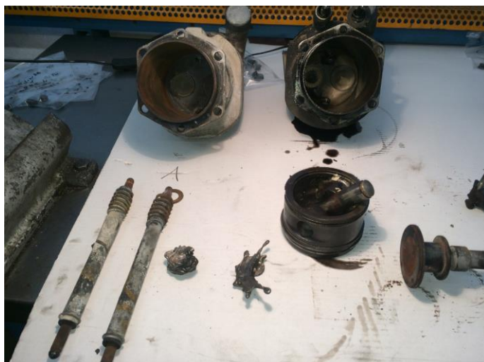
Foto 40: particolare delle aste dei bilancieri e delle punterie.
