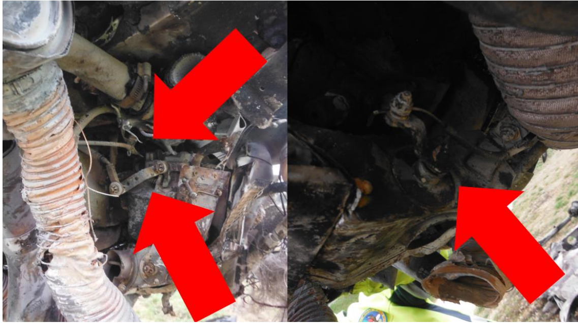
Foto 19 e 20: dettaglio della posizione dei cavi di comando della manetta di potenza e dell'aria calda al carburatore.
