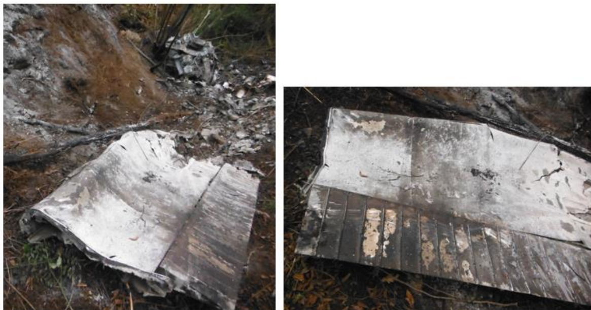
Foto 10 e 11: dettaglio della semiala destra dell'aeromobile.
