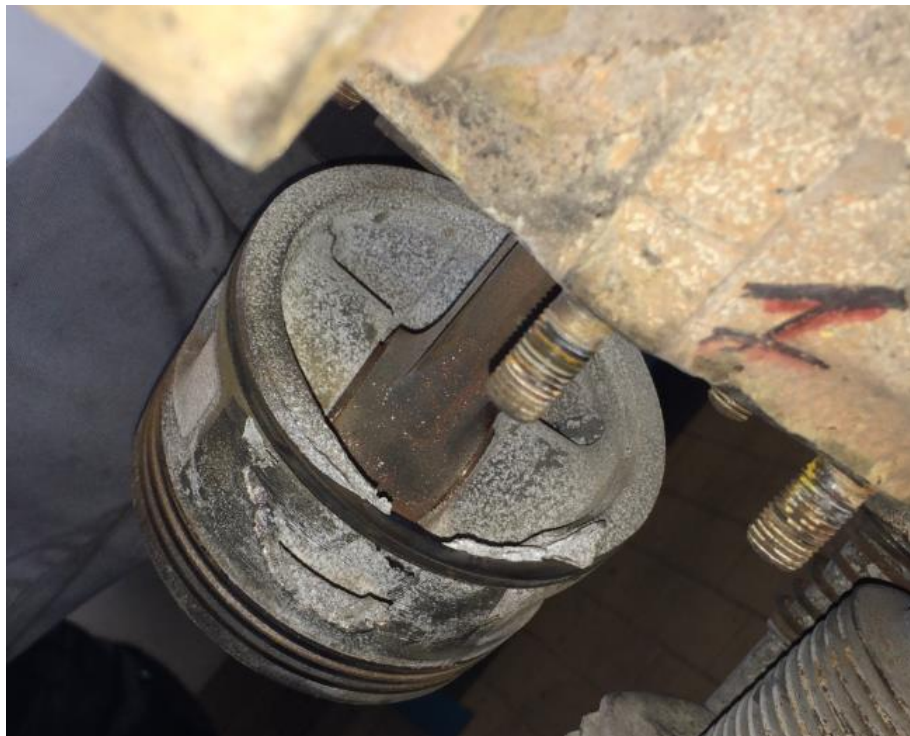
Foto 39: particolare dell'interno del pistone n. 1.
