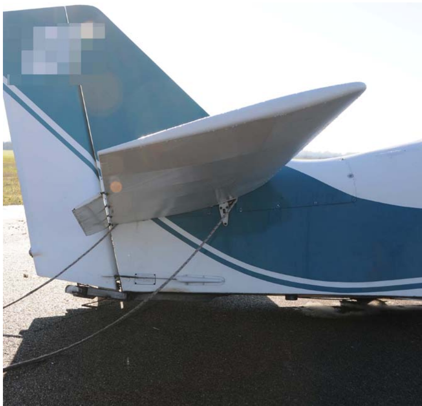
Foto 6: spezzone della fune di traino avvolta allo stabilizzatore.
