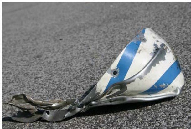
Foto 11: deformazione dell'ogiva dell'elica.
