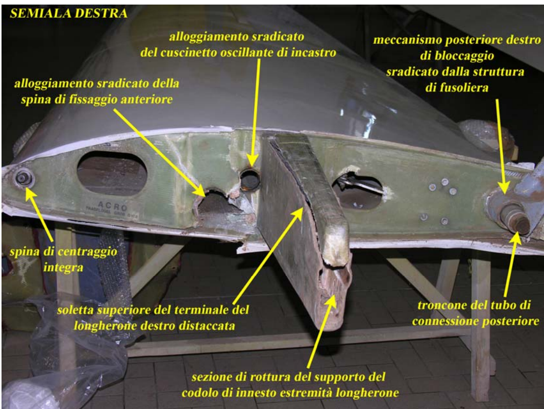
Foto 14: evidenze sulla radice semiala destra, con riposizionamento soletta superiore.
