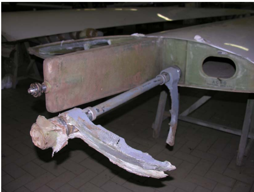
Foto 9: tubo di connessione anteriore con relativi supporti sradicati dalla fusoliera e relative spine di fissaggio inserite e bloccate.
