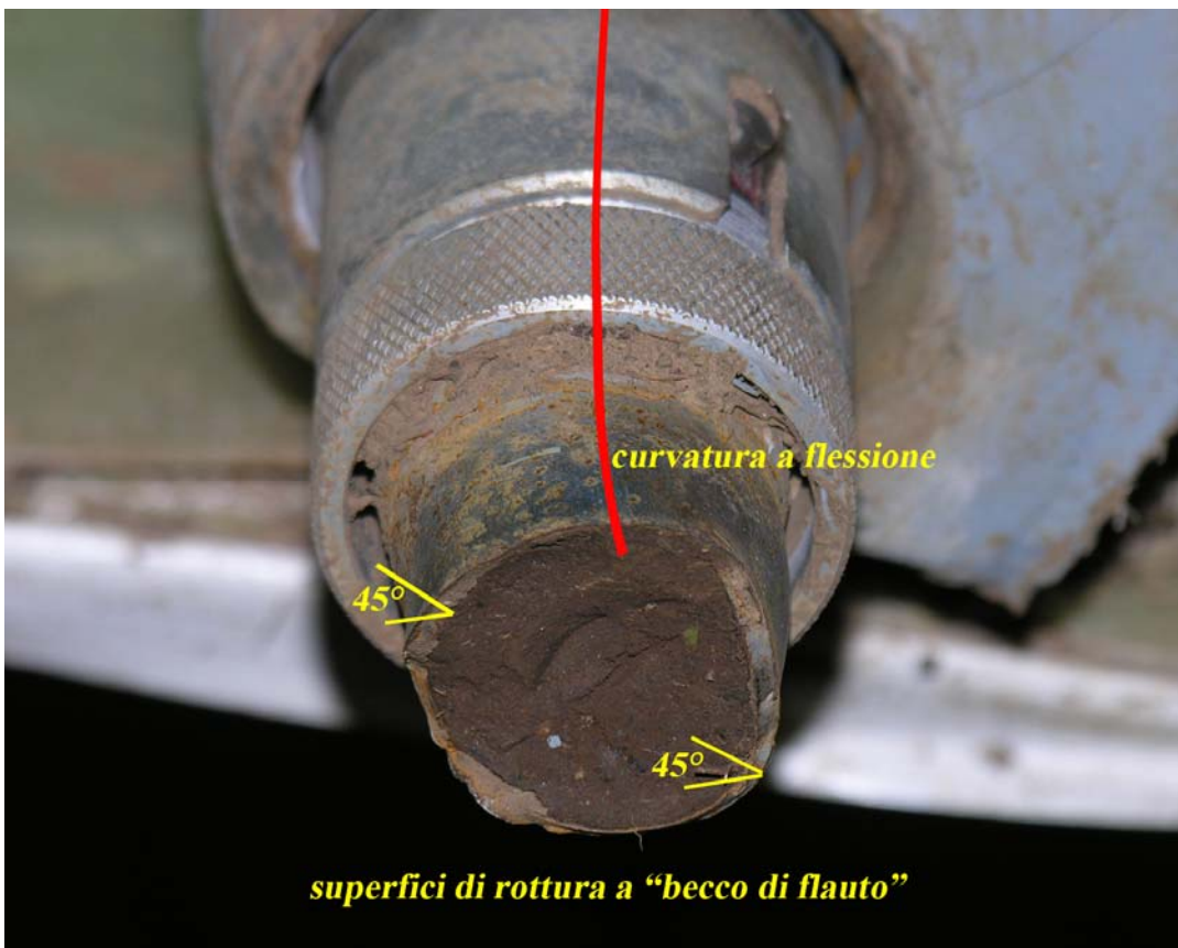
Foto 12: troncone del tubo di connessione posteriore.
