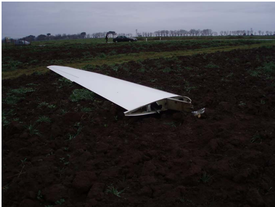
Foto 7: semiala sinistra sul luogo dell'incidente.
