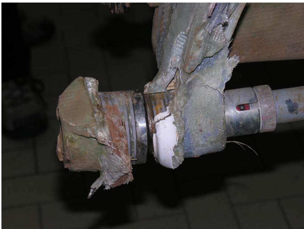
Foto 10: spina di fissaggio semiala destra con supporto sradicato dalla centina.
