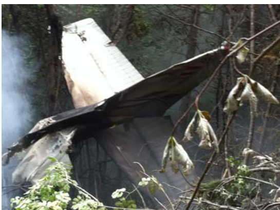
Foto 12: resti della coda e degli impennaggi.
