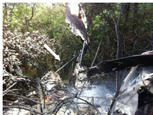
Foto 15: montante di supporto semiala sinistra.
