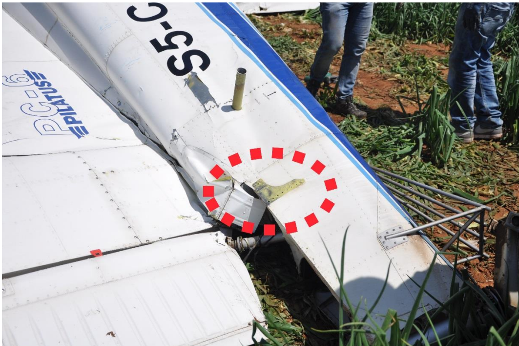
Foto 31: punto di fissaggio della piastra di vincolo dello stabilizzatore alla fusoliera, lato destro.
