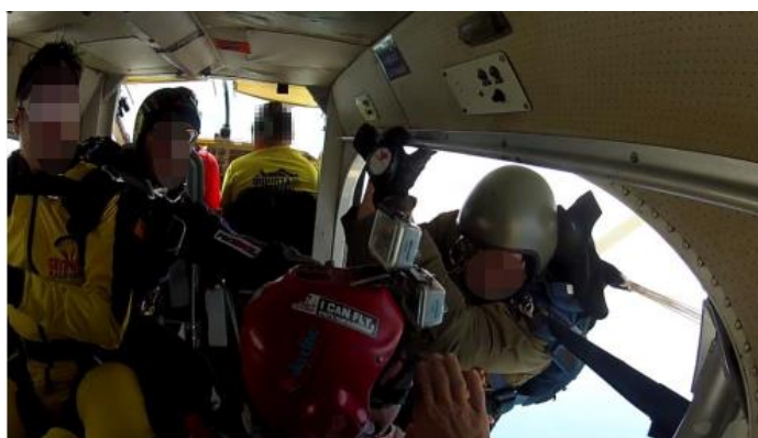
Foto 10: bretelle del paracadute ausiliario in tensione trascinano il paracadutista.
