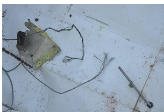
Foto 33 (a sinistra): cavi di comando dell'equilibratore (porzione dalla barra di comando presente all'interno della fusoliera). Foto 34 (a destra): cavi di comando dell'equilibratore (porzione rimasta vincolata al piano di coda).
