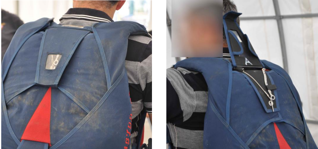
Foto 41 e 42: particolare del sistema di chiusura del contenitore del paracadute ausiliario.
