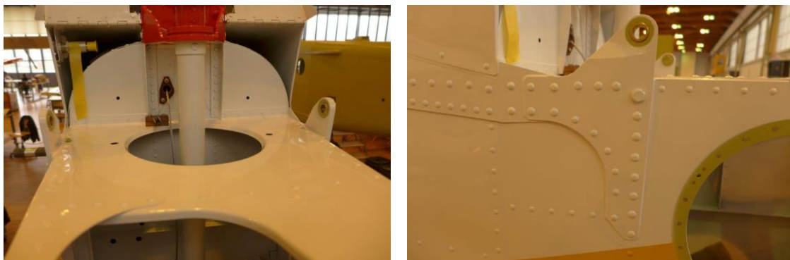
Foto 1 e 2: piastre con fori ove viene fissato lo stabilizzatore (fonte Pilatus).
