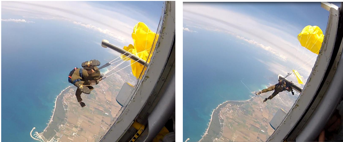
Foto 11 e 12: spiegamento della velatura del paracadute ausiliario al di sopra dello stabilizzatore lato destro.
