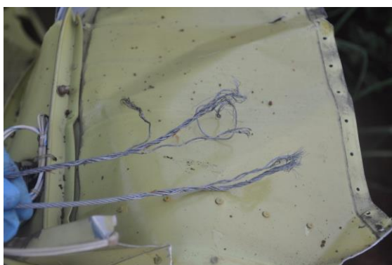
Foto 33 (a sinistra): cavi di comando dell'equilibratore (porzione dalla barra di comando presente all'interno della fusoliera). Foto 34 (a destra): cavi di comando dell'equilibratore (porzione rimasta vincolata al piano di coda).
