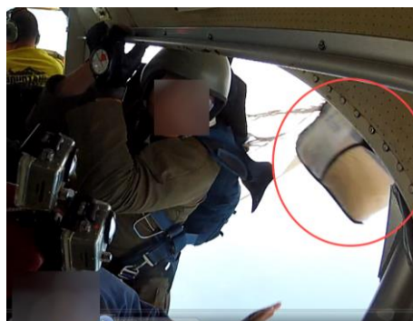
Foto 8 e 9: fuoriuscita del pilotino a molla e free bag contenente paracadute ausiliario.
