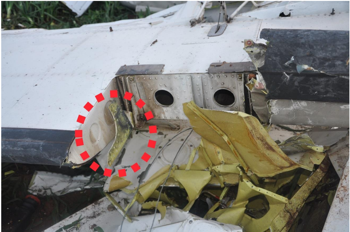
Foto 30: piastra di fissaggio dello stabilizzatore alla fusoliera (lato destro).
