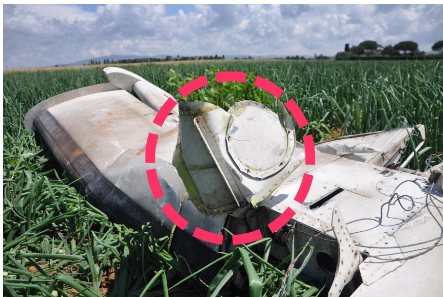
Foto 32: punto di attacco dello stabilizzatore, lato sinistro, con lembo di fusoliera.
