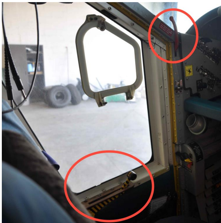
Foto 39: particolare del sistema di apertura e di sbloccaggio della porta su un velivolo di tipo uguale a quello coinvolto nell'incidente.
