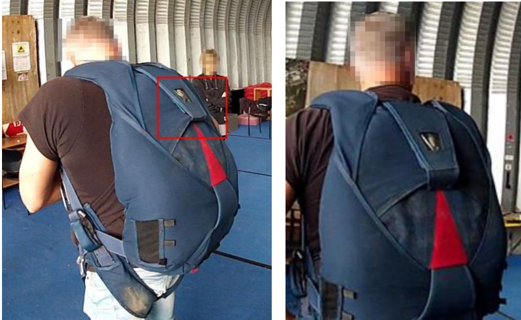
Foto 52 e 53: mancata tenuta della chiusura della pattina di protezione dopo il ripiegamento successivo all'incidente.
