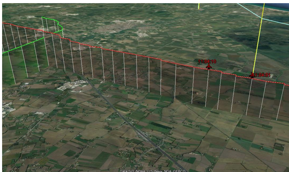
Figura 5: rappresentazione grafica (con osservatore posto a Nord-Ovest) delle posizioni dell'AFL2597 nel momento in cui attraversava il confine comune fra i due CTR (11.04'01") e nel momento in cui il CTA PLN di Venezia APP tentava il coordinamento con il collega di Treviso APP (11.04'10").
