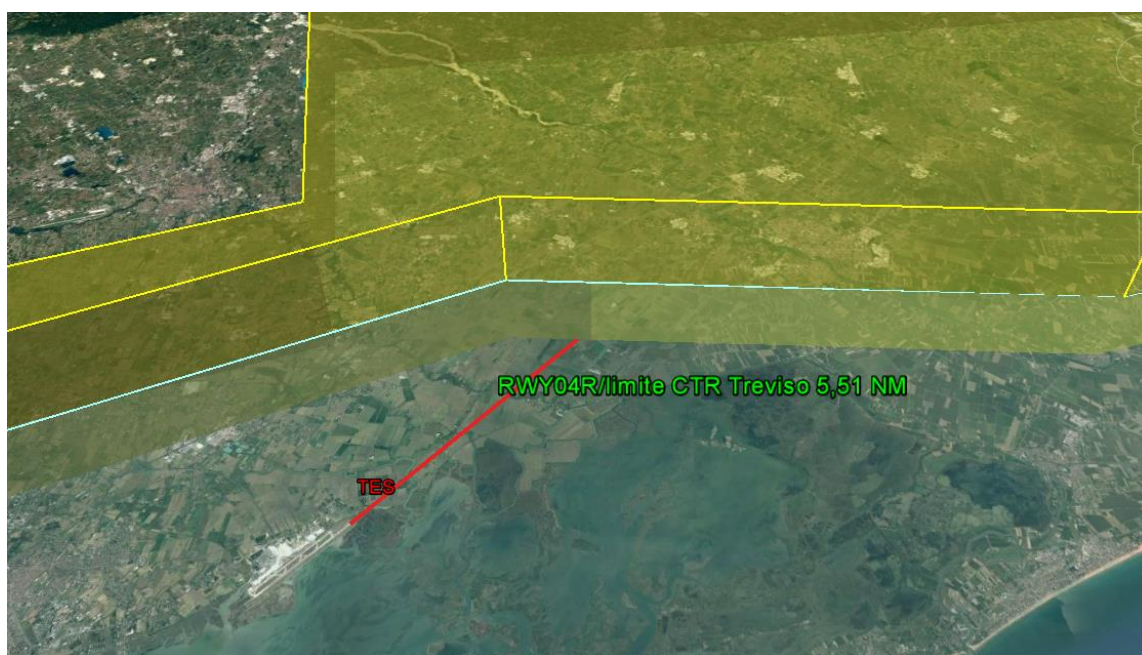
Figura 2: posizione dell'aeroporto di Venezia Tessa rispetto al confine con lo spazio aereo del CTR di Treviso e rappresentazione grafica della distanza fra la fine della pista 04R rispetto a detto confine (linea rossa), lungo il suo naturale prolungamento.
