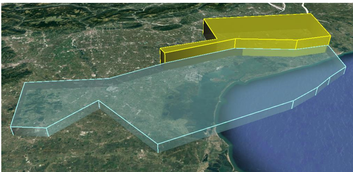
Figura 1: rappresentazione tridimensionale del volume della zona 2 del CTR di Venezia (in celeste) a confronto (almeno per la parte a confine) con il volume della zona 3 del CTR di Treviso (in giallo).
