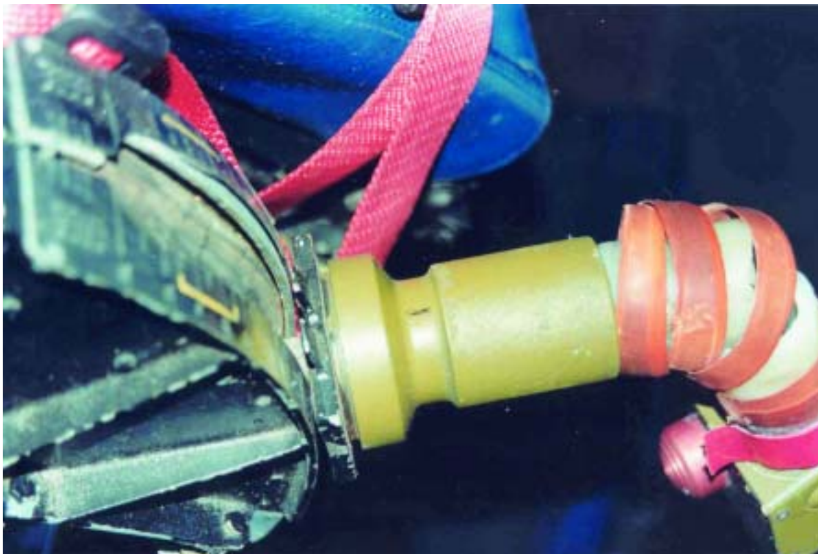
Il dettaglio del comando passo collettivo pilota evidenzia, per completezza informativa, la tacca di riferimento per la verifica dello stato di frizionamento rilevato.
