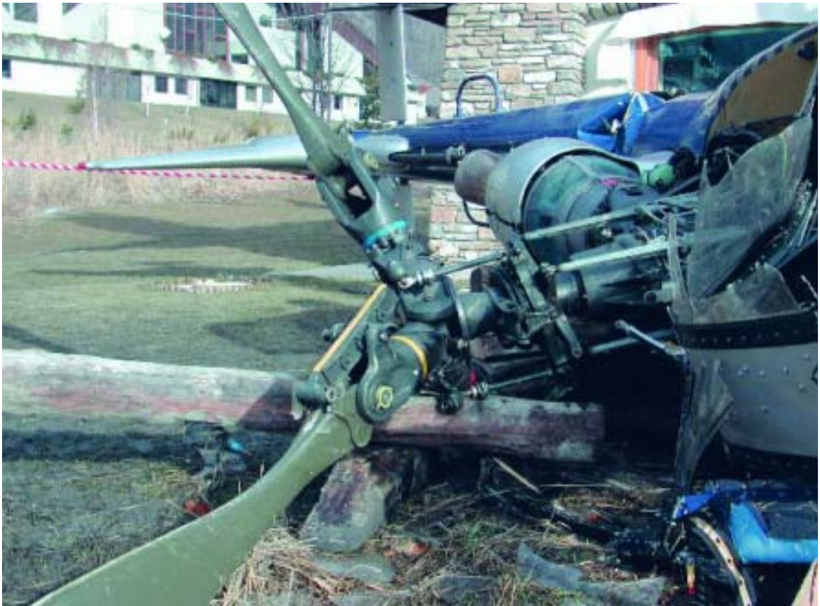
Il rilievo sul gruppo mozzo rotore principale-pale consente di stabilire la sequenza di urto delle pale con il terreno: pala rossa, pala gialla e pala blu in sequenza.
