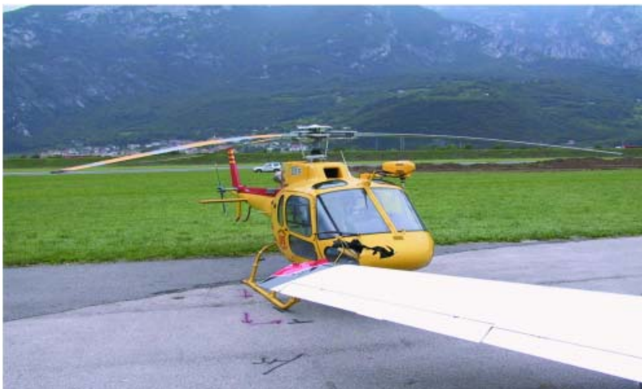
Gli aeromobili dopo l'urto. A terra segni dello spostamento dell'elicottero a seguito dell'impatto.
