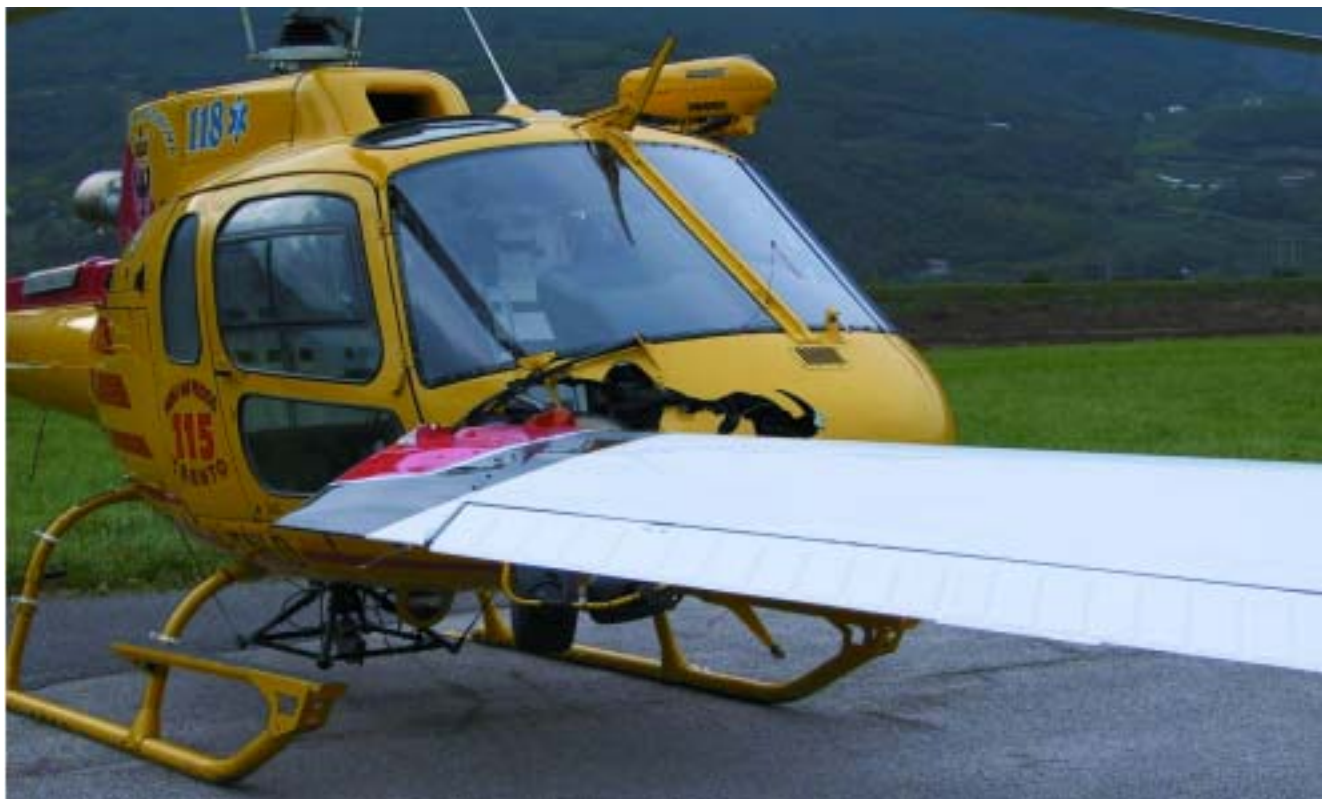
Punto di contatto fra gli aeromobili rilevato subito dopo l'evento.
