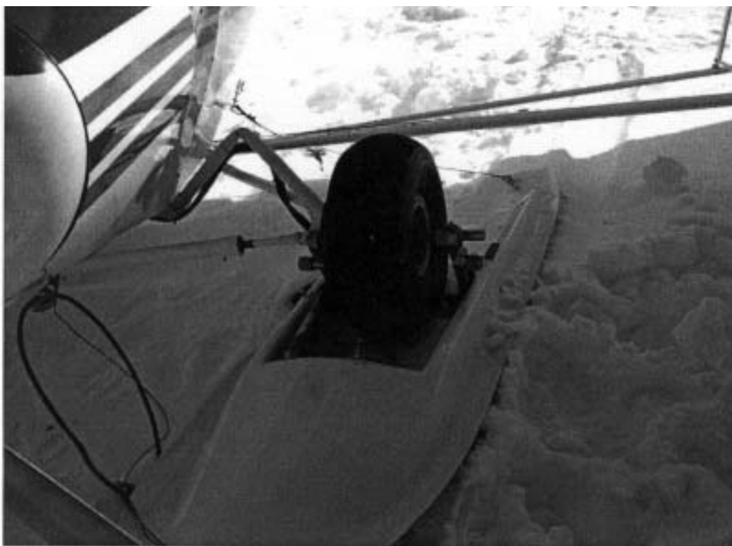
Particolare del trapezio carrello danneggiato.
