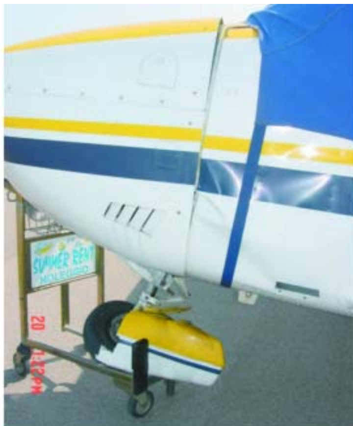
Particolare carrello danneggiato.
